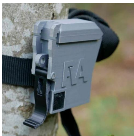
Figura 3: Caixa protetora para AudioMoth impermeável e com trava. Fonte: https://www.thingiverse.com/thing:6428228
