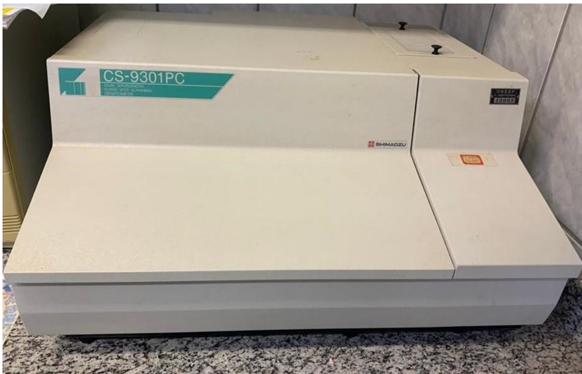
Figura 6. Densitômetro computadorizado (Shimadzu CS-9301 PC, Shimadzu).
