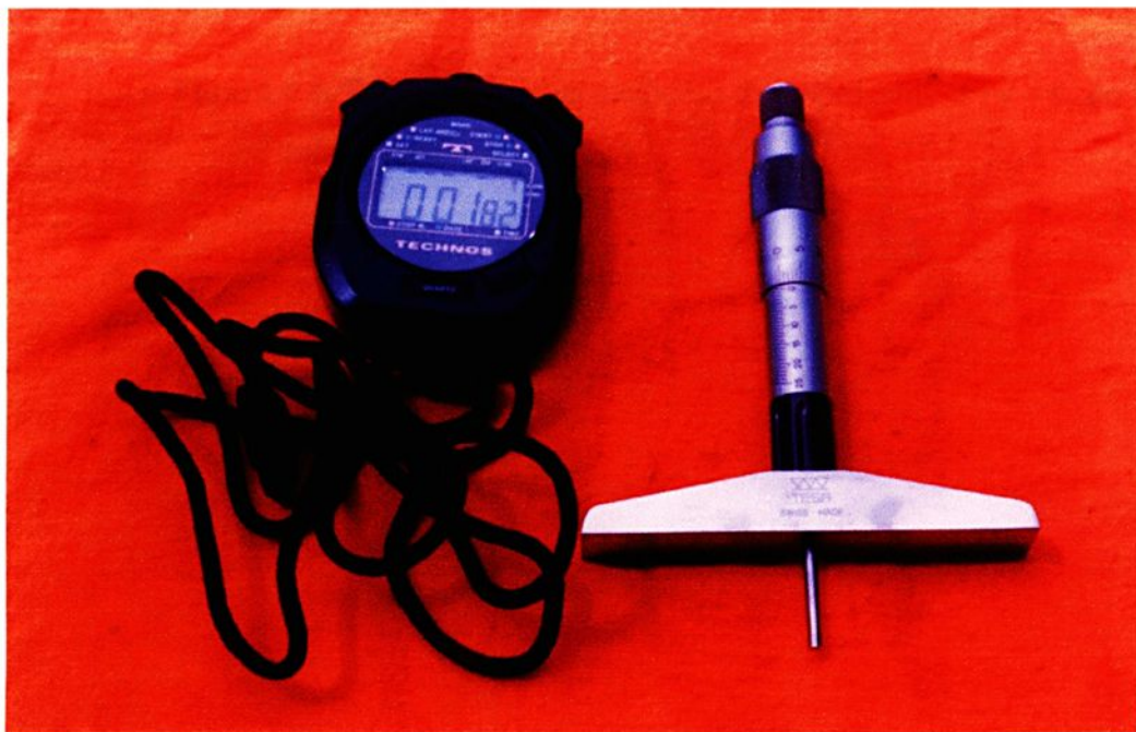
Figura 4.5. Fotos do cronômetro e micrômetro de profundidade utilizados nos ensaios.
