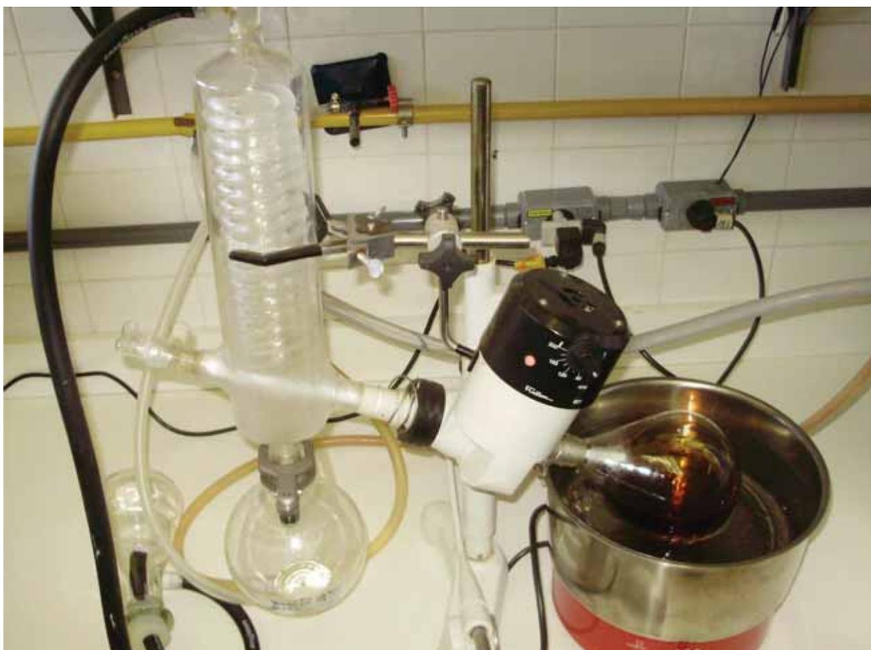
Processo de evaporação do solvente em rota vapor
