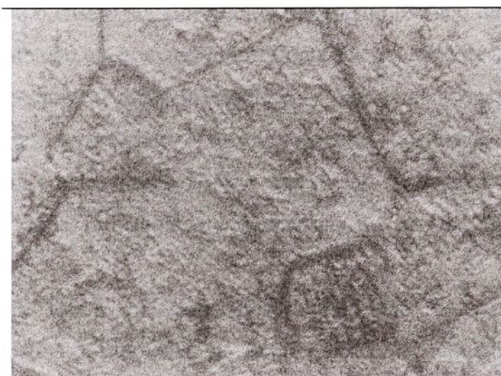
Figura 5 b -Ti-15V-3Cr-3Sn-3Al envelhecida à 500°C durante 2 horas, (aumento 400x).
