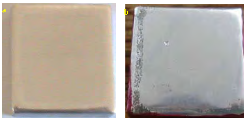
Figura 5.5.12: (a) Imagem da amostra com filme de 45 W antes do ensaio e (b) após 145 h de exposição à névoa salina.
