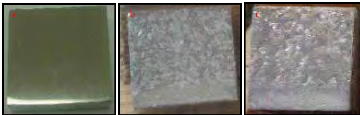
Figura 5.4.5: (a) Imagem da liga de alumínio 2024 como recebida e após (b) 4 h e (c) 60 h de exposição à névoa salina.
