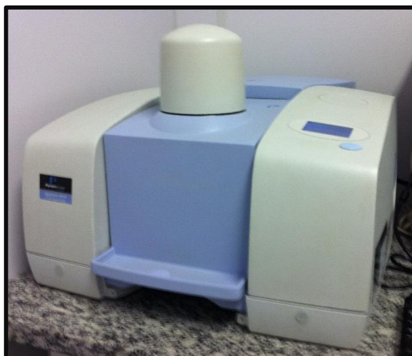
Figura 11: Espectrômetro no infravermelho próximo utilizados para as análises dos grãos de café (Disponível na Embrapa Instrumentação - São Carlos).
