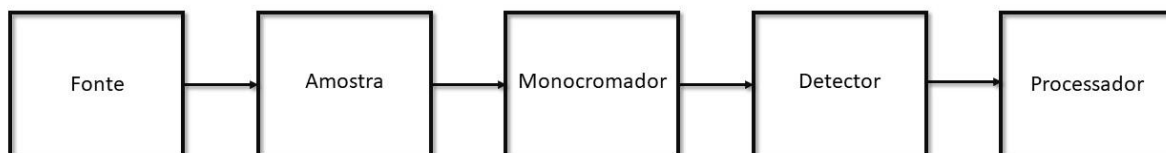
Figura 4: Representação esquemática de um espectrômetro NIRS.
