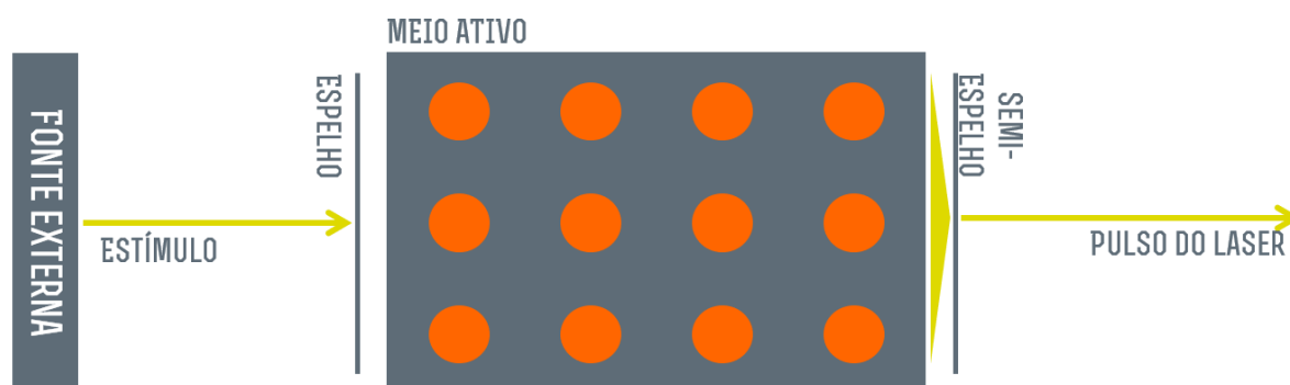
Figura 6: Representação esquemática simplificada de um laser visando a emissão estimulada e consequentemente formação da luz laser.
