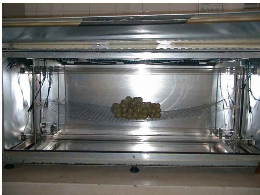
Apêndice 6. Cachos de uva 'Itália' no interior do equipamento de irradiação UV-C.
