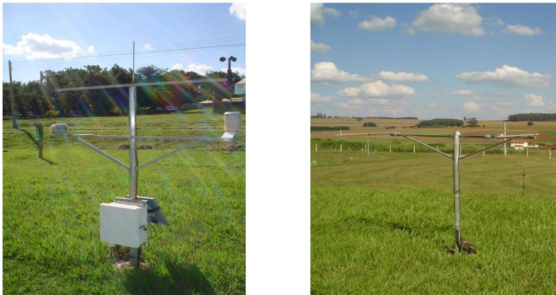
Figura 2. Estação Meteorológica Automática da marca Campbell *Scientific*
