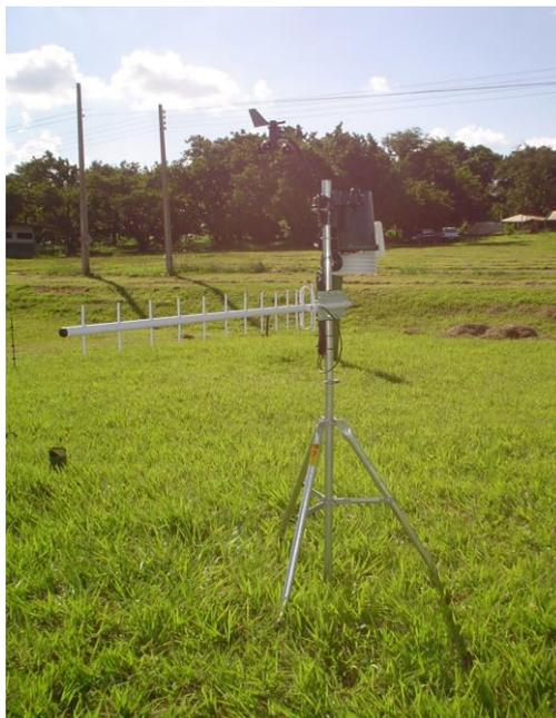
Figura 1. Estação Meteorológica Automática da marca Davis Instruments
