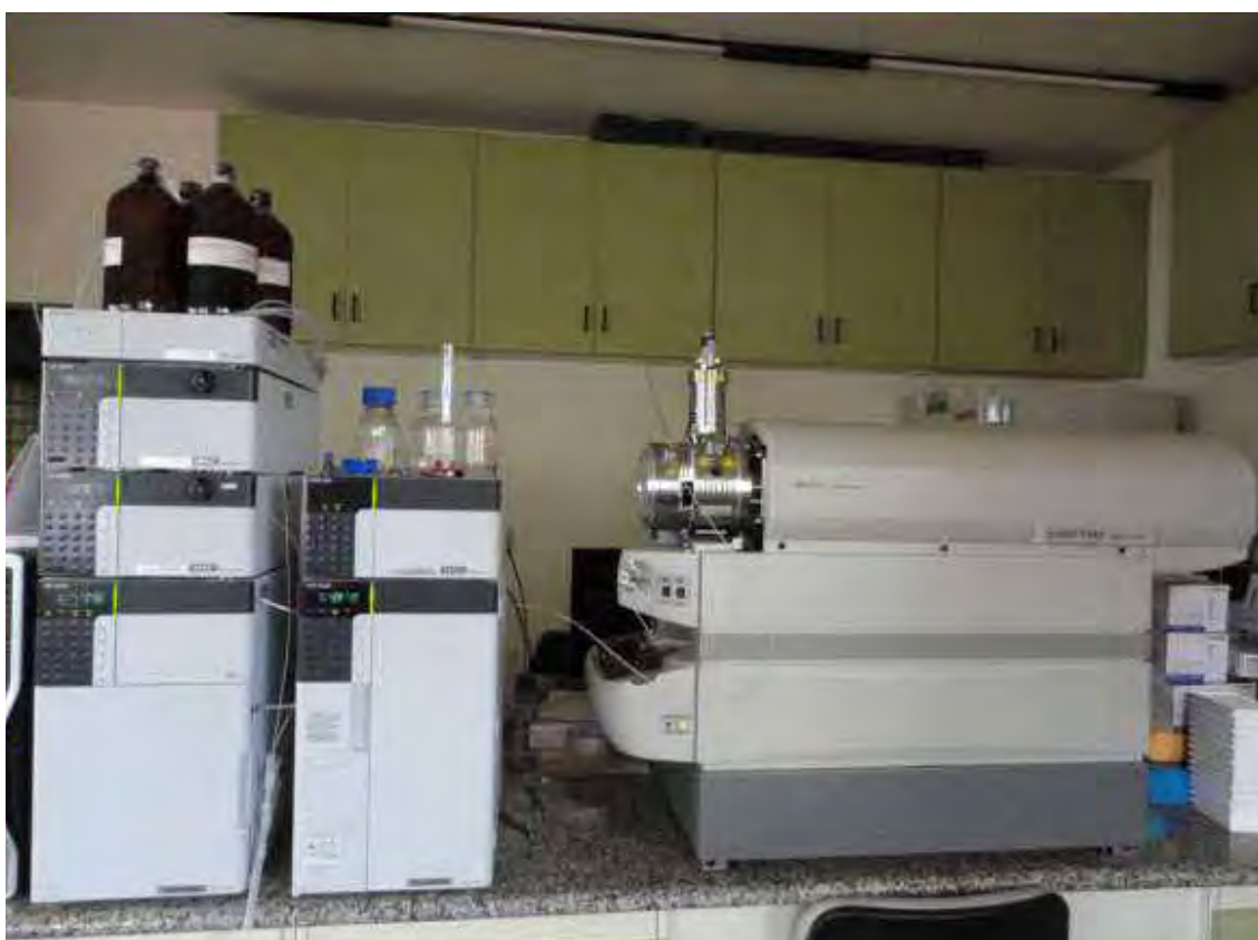
Figura 6. Cromatógrafo Liquido (Proeminence UFLC) acoplado ao espectrômetro de massas (3200 Q TRAP) LC-MS/MS. Botucatu/SP, 2012.
