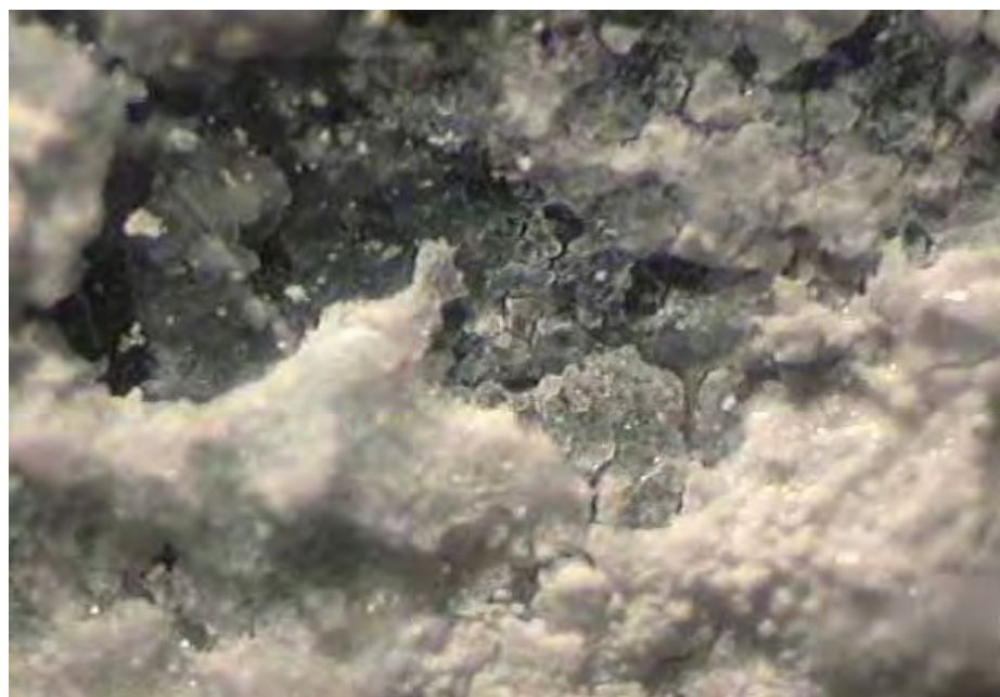
Figura 137 - Micrografia ótica da superfície da liga 7050 após imersão em NaCl 5% na presença de NaNO 3 0,1M mostrando uma grande quantidade de produtos de corrosão com coloração branca aderidos em sua superfície.
