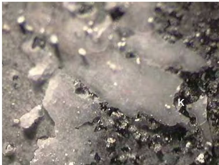
Figura 25 - MO da liga 7010-R exhibe a fragilidade de filme (K) formado sobre a superfície da liga
