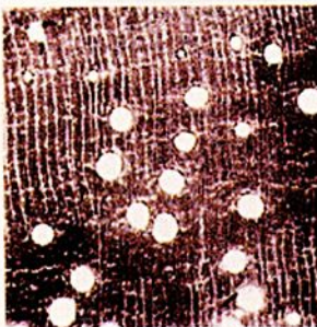
e) Gaiac. Madeira densa. Fibras com paredes grossas.
