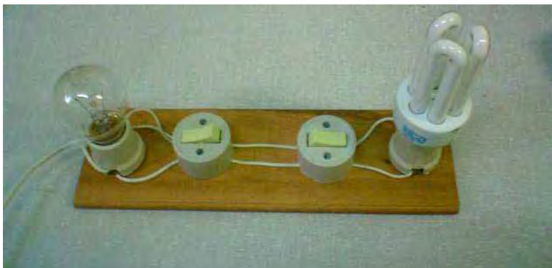
Figura 6.23: Kit experimental utilizado para discussão sobre eficiência energética em lâmpadas
