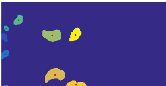
As coordenadas dos centros de massa das aves obtidas em cada *frame* analisado foram armazenadas em uma variável para posterior análise. O código desse processamento e análise das imagens pode ser visualizado no Anexo I e foi aplicado em vídeos de 5 minutos analisando *frames* a cada 1 segundo (captura das imagens foi a 30 fps) para o experimento com galinhas poedeiras e 7 minutos analisando *frames* a cada 1 segundo (captura das imagens foi a 2 fps) para o experimento com matrizes pesadas.
