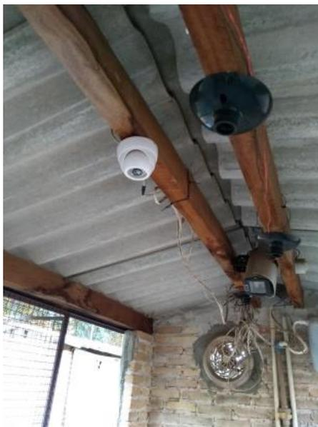
Para a captura das imagens foram instaladas câmeras de vídeo modelo AP2688W, marca POWER® com sensor de imagem charge-coupled-device(ccd) analógico, com resolução de 1200 linhas, lente de 3,6 mm, com abertura de 60° e padrão de vídeo NTSC–*National Television System(s) Committee* ou, em português Comitê Nacional do(s) Sistema(s) de Televisão.
