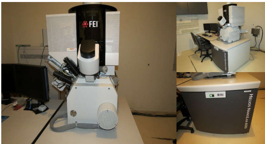
Figura 5. Microscópio eletrônico de varredura de feixe duplo, FEI - modelo Helios Nanolab 600i, do laboratório de Microscopia Avançada do Instituto de Química/UNESP/Araraquara.
