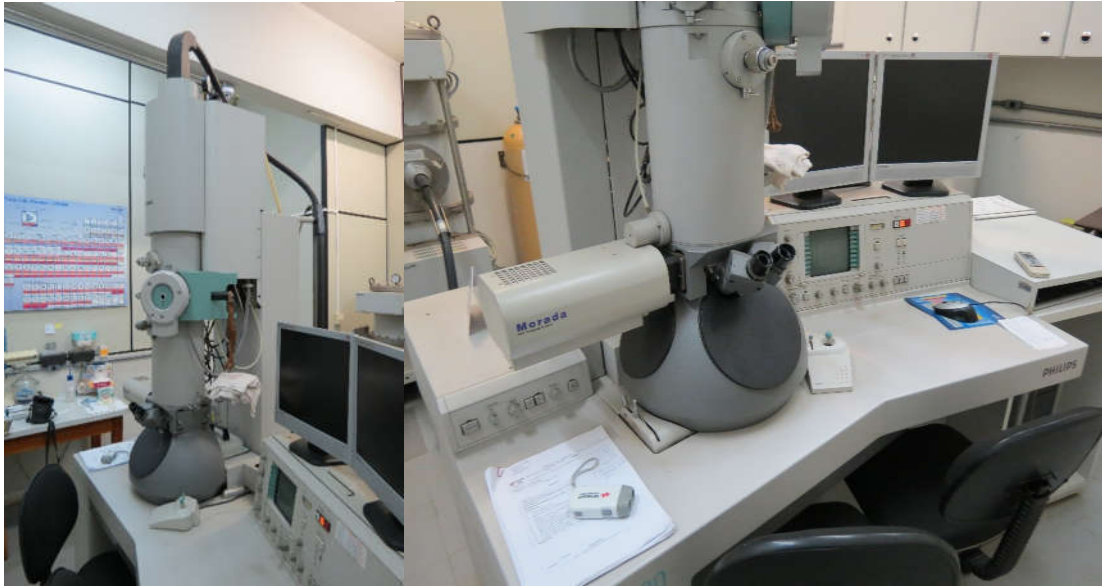
Figura 6. Microscópio eletrônico de transmissão Philips CM200 - Laboratório de Microscopia Eletrônica do Instituto de Química/UNESP/Araraquara.
