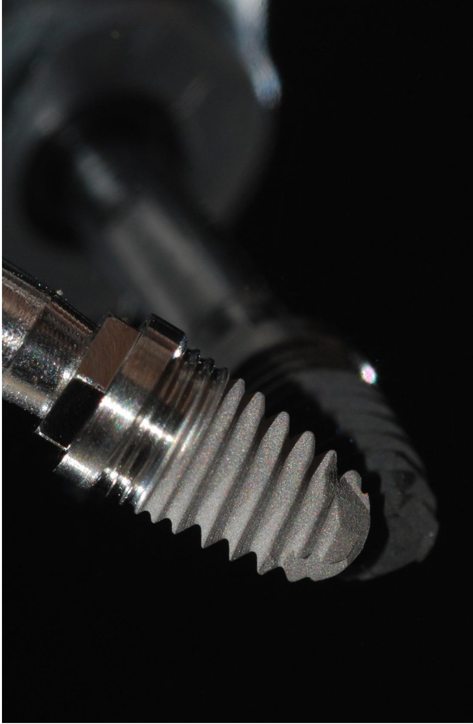
Fig. 1: Implante dentário de Ticp, com superfície usinada nas 2 primeiras espiras e tratada com duplo ataque ácido nas demais, de diâmetro de 3,6 mm e 6,5 mm de altura, plataforma hexágono externo (Implalife® Indústria de Produtos Médico -Odontológicos, linha Atrofic, Jales, SP, Brasil).
