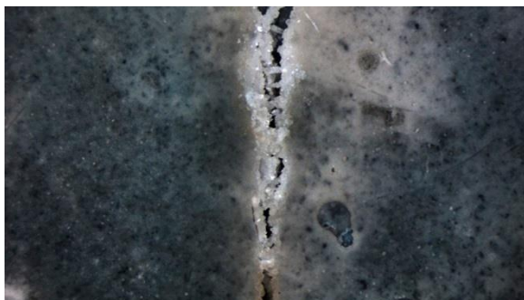
Figura 5 – Fechamento de fissuras em bioconcreto pela produção de carbonato de cálcio por bactérias.
