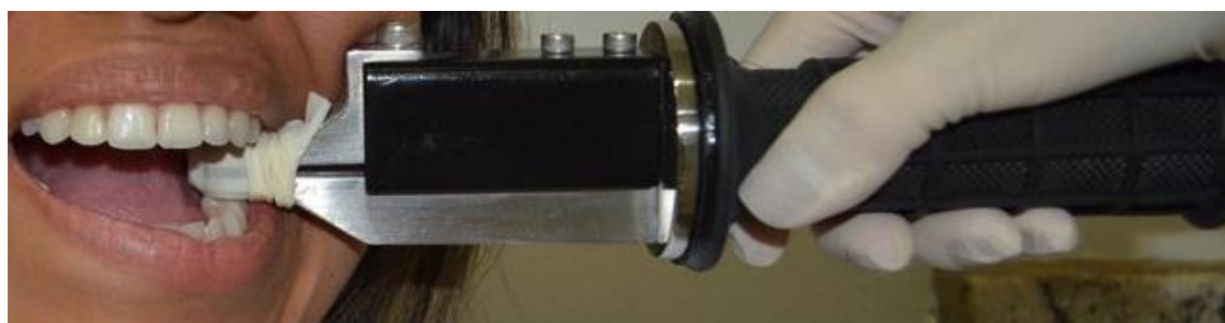
Figura 17 - Transdutor de metal protegido com dedeiras de látex no momento do teste
