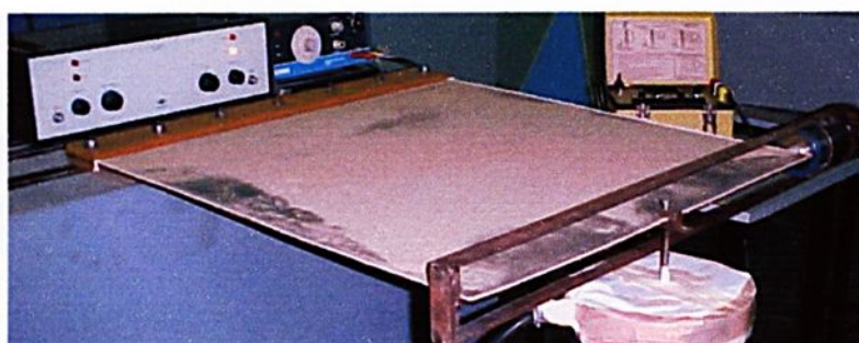
FIGURA 8.138 - Exper.(NL) modo 5 - Frequência natural 45,70 Hz - F=1400\text{N}
