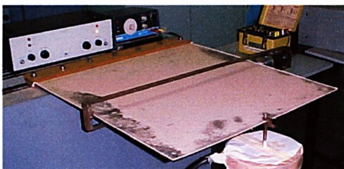
FIGURA 8.72 - Exper.(NL) modo 4 - Frequência natural 37,70 Hz – F=3500N
