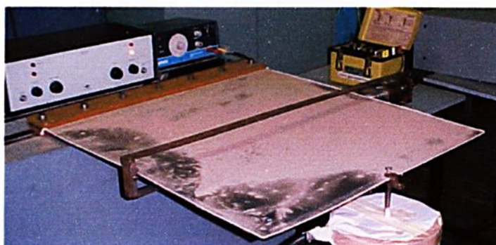
FIGURA 8.74 - Exper.(NL) modo 5 - Frequência natural 44,50 Hz – F=3500\text{N}
