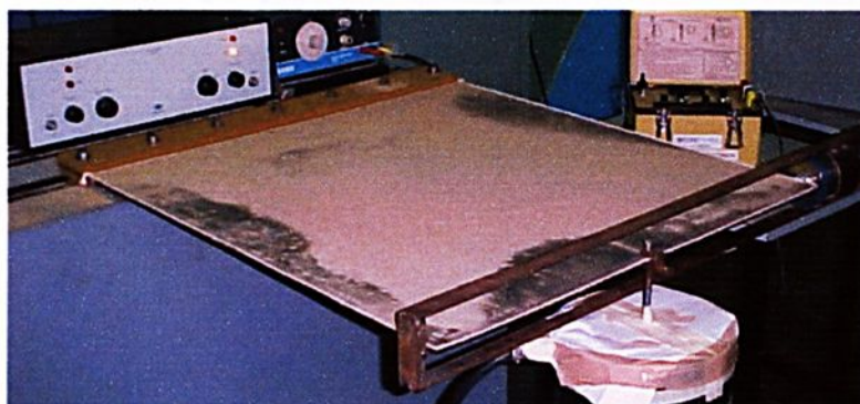
FIGURA 8.120 - Exper.(NL) modo 4 - Frequência natural 38,20 Hz - F=1000\text{N}
