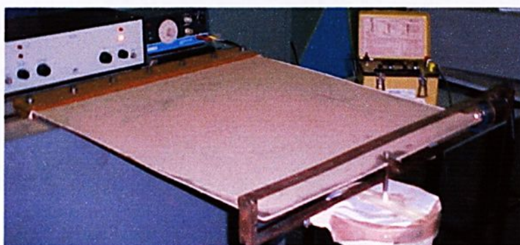
FIGURA 8.98 - Exper.(NL) modo 1 - Frequência natural 3,75 Hz - F=800\text{N}
