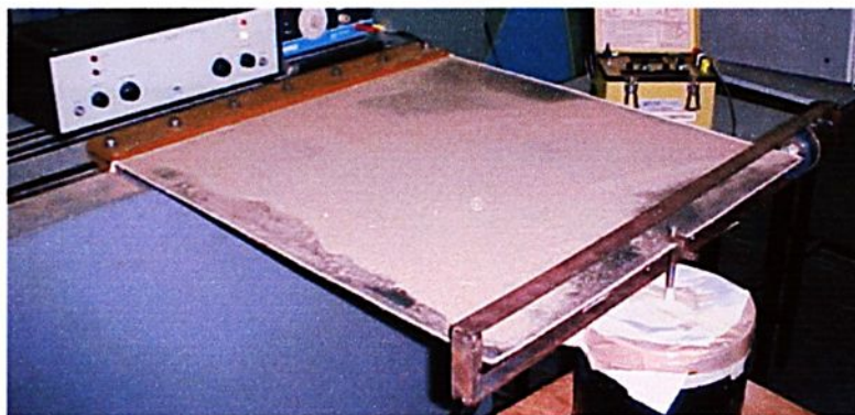
FIGURA 8.96 - Exper.(NL) modo 8 - Frequência natural 101,50 Hz – F=28N
