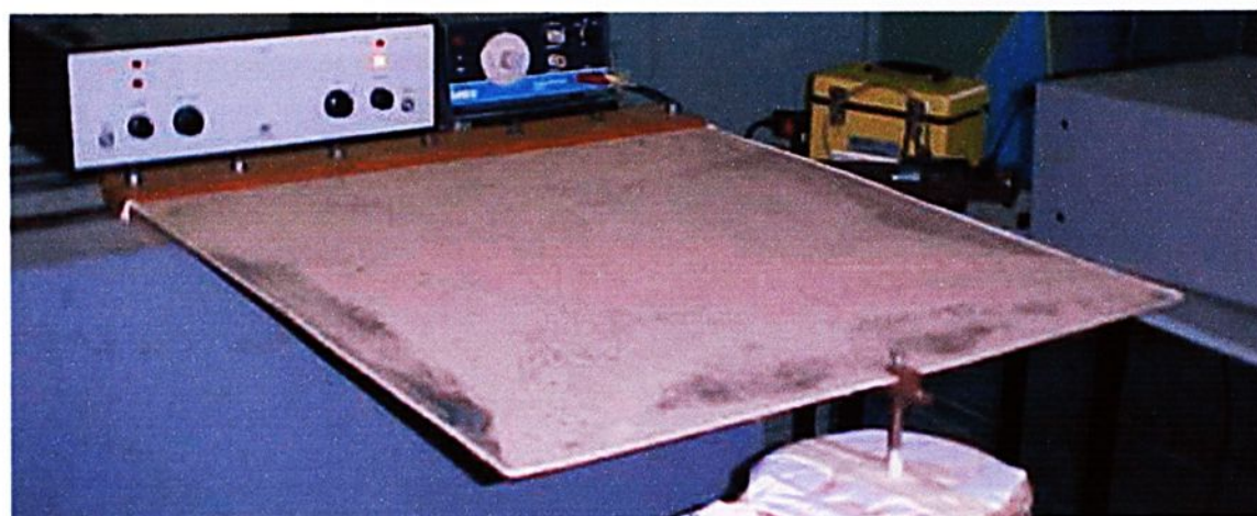
FIGURA 6.6 - Experimental(L) modo 3 - Frequência natural de 32,40 Hz
