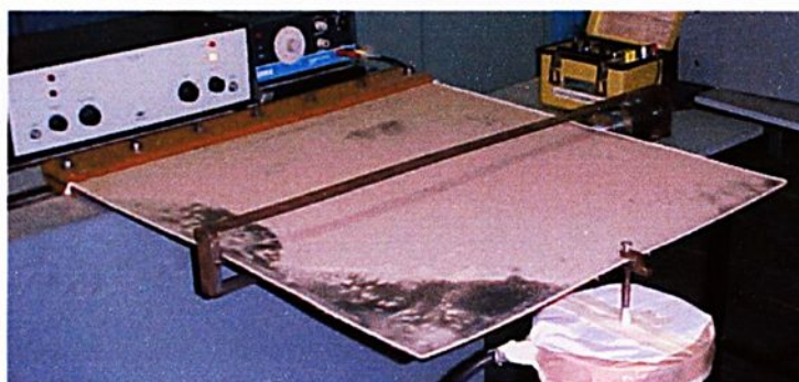
FIGURA 8.58 - Exper.(NL) modo 5 - Frequência natural 44,50 Hz – F=3000\text{N}
