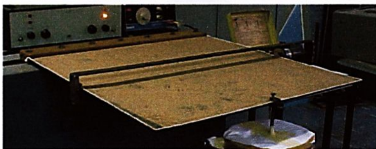
FIGURA 8.2 – Exper.(NL) modo 1 - Frequência natural de 4,75 Hz - F=28\text{N}
