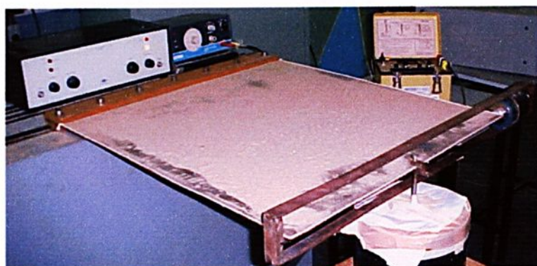
FIGURA 8.86 - Exper.(NL) modo 3 - Frequência natural 32,00 Hz – F=28N
