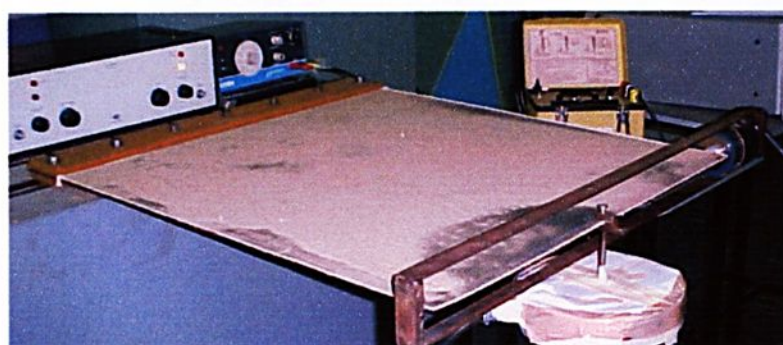
FIGURA 8.140 - Exper.(NL) modo 6 - Frequência natural 81,75 Hz - F=1400\text{N}
