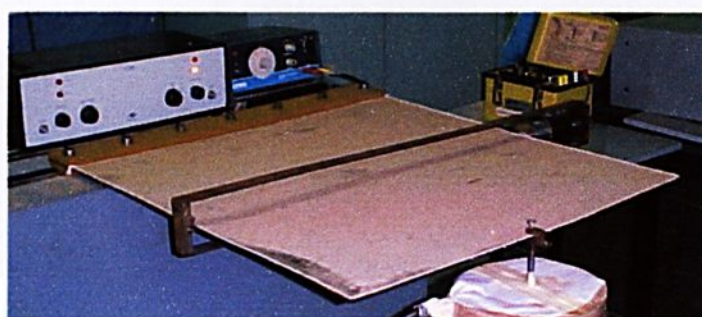
FIGURA 8.50 - Exper.(NL) modo 1 - Frequência natural 5,20 Hz – F=3000\text{N}
