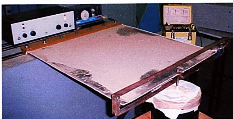
FIGURA 8.90 - Exper.(NL) modo 5 - Frequência natural 50,25 Hz – F=28\text{N}
