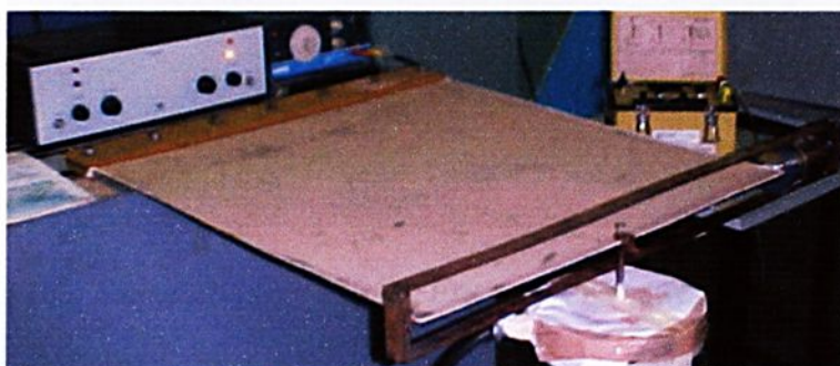
FIGURA 8.114 - Exper.(NL) modo 1 - Frequência natural 3,75 Hz - F=1000\text{N}
