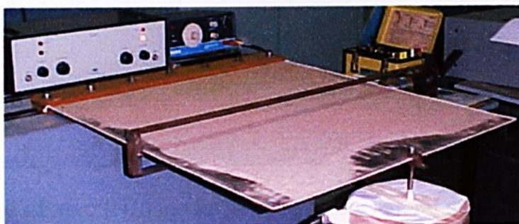
FIGURA 8.6 - Exper.(NL) modo 3 - Frequência natural de 33,00 Hz – F=28\text{N}
