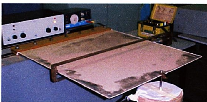
FIGURA 8.48 - Exper.(NL) modo 8 - Frequência natural 92,50 Hz - F=2000\text{N}
