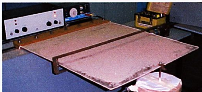
FIGURA 8.68 - Exper.(NL) modo 2 - Frequência natural 10,50 Hz – F=3500\text{N}
