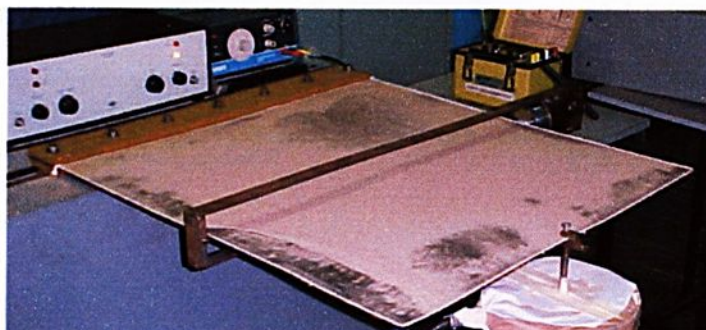
FIGURA 8.46 - Exper.(NL) modo 7 - Frequência natural 87,20 Hz - F=2000\text{N}
