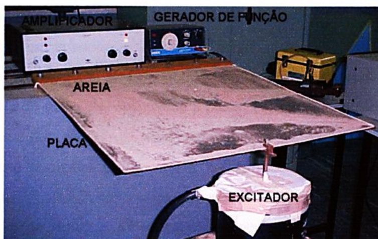
FIGURA 4.7 – Ensaio experimental para obter modo de vibração da placa geometricamente linear.
