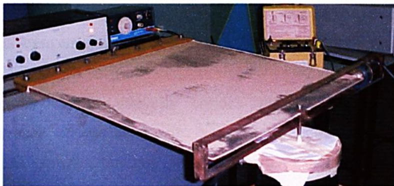
FIGURA 8.144 - Exper.(NL) modo 8 - Frequência natural 94,20 Hz- F=1400\text{N}
