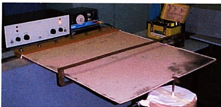
FIGURA 8.54 - Exper.(NL) modo 3 - Frequência natural 28,50 Hz – F=3000N
