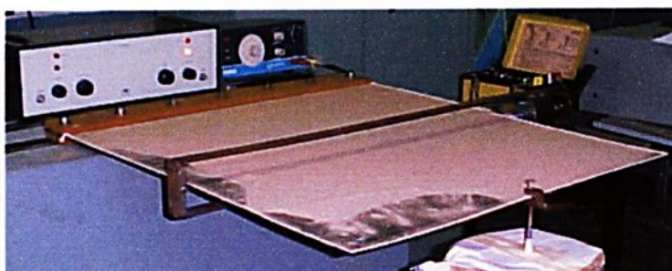
FIGURA 8.8 - Exper.(NL) modo 4 - Frequência natural de 41,50 Hz – F=28\text{N}
