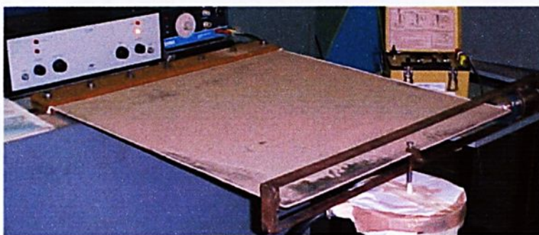
FIGURA 8.116 - Exper.(NL) modo 2 - Frequência natural 11,50 Hz - F=1000\text{N}
