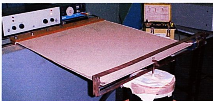
FIGURA 8.82 - Exper.(NL) modo 1 - Frequência natural 3,75 Hz – F=28\text{N}
