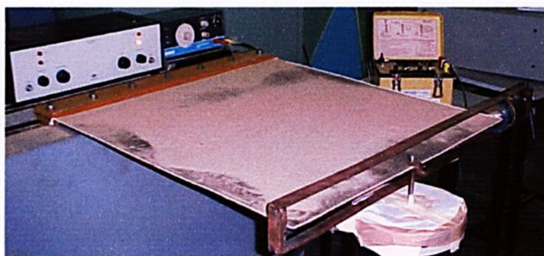
FIGURA 8.106 - Exper.(NL) modo 5 - Frequência natural 47,50 Hz - F=800\text{N}
