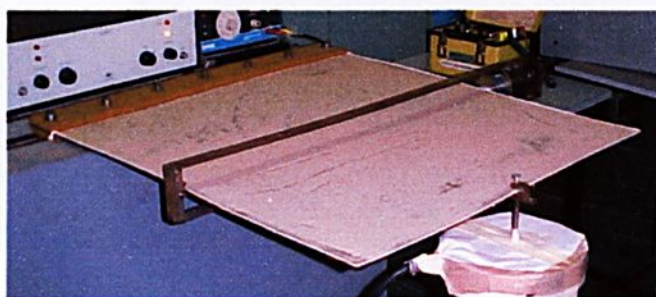
FIGURA 8.34 - Exper.(NL) modo 1 - Frequência natural 5,00 Hz - F=2000\text{N}
