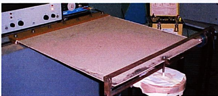
FIGURA 8.100 - Exper.(NL) modo 2 - Frequência natural 11,60 Hz - F=800\text{N}
