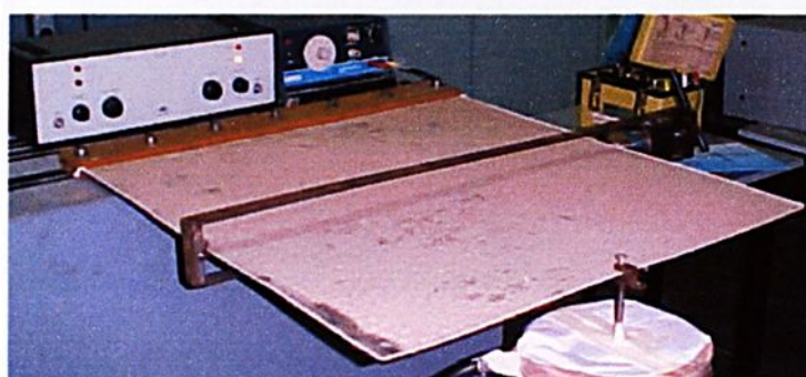
FIGURA 8.18 - Exper.(NL) modo 1 - Frequência natural de 4,75 Hz - F=1000\text{N}
