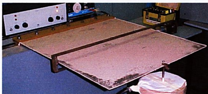
FIGURA 8.52 - Exper.(NL) modo 2 - Frequência natural 10,50 Hz – F=3000\text{N}
