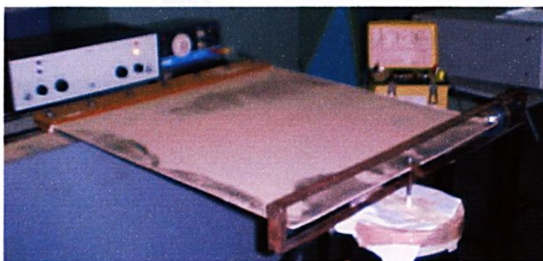
FIGURA 8.126 - Exper.(NL) modo 7 - Frequência natural 91,00 Hz - F=1000\text{N}
