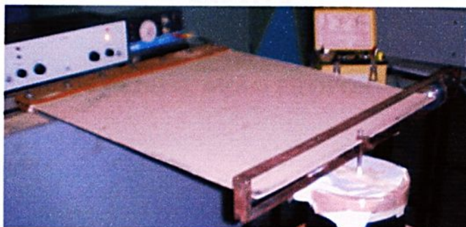
FIGURA 9.4 - Modo 1 Exper.(NL) - Frequência natural 3,75 Hz – F=1400N
