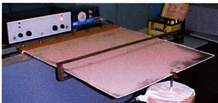
FIGURA 8.70 - Exper.(NL) modo 3 - Frequência natural 29,70 Hz – F=3500N
