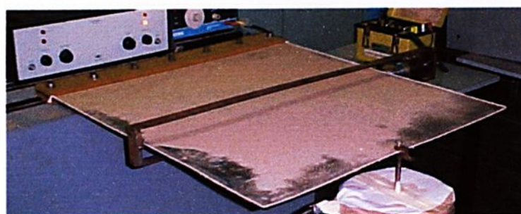
FIGURA 8.38 - Exper.(NL) modo 3 - Frequência natural 28,50 Hz - F=2000N
