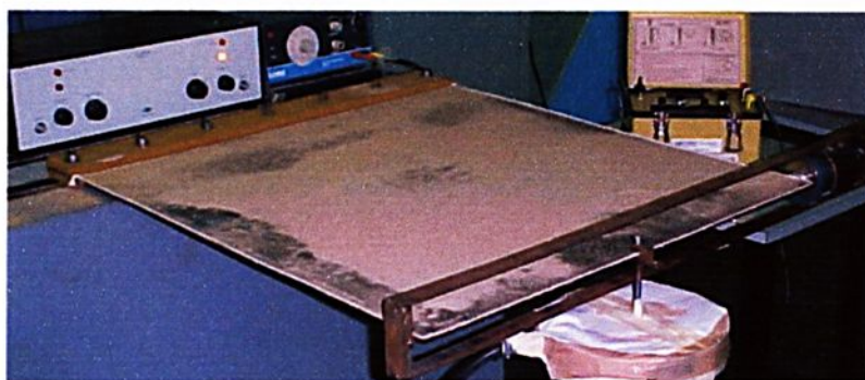
FIGURA 8.122 - Exper.(NL) modo 5 - Frequência natural 50,20 Hz - F=1000\text{N}
