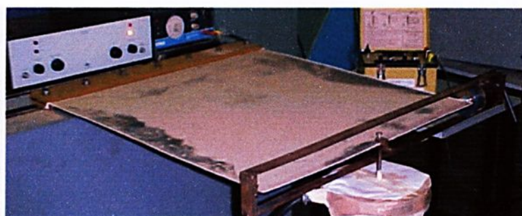
FIGURA 8.118 - Exper.(NL) modo 3 - Frequência natural 33,50 Hz - F=1000\text{N}
