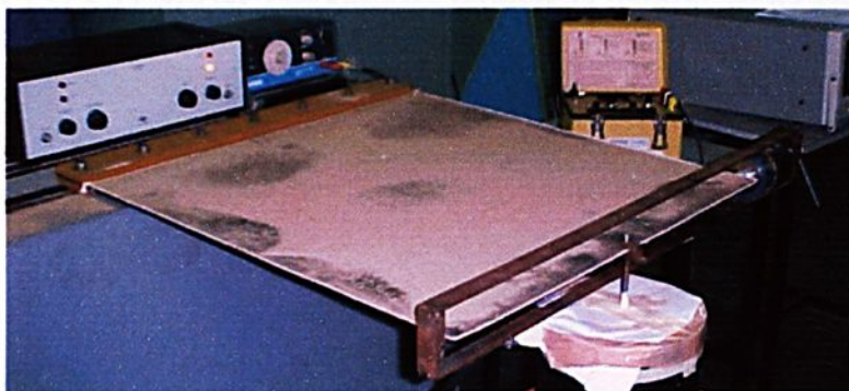
FIGURA 8.128 - Exper.(NL) modo 8 - Frequência natural 97,00 Hz - F=1000\text{N}
