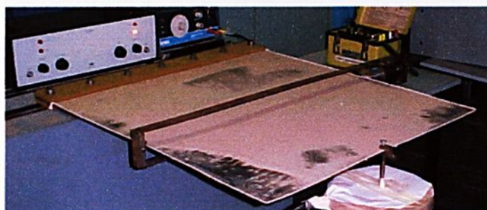
FIGURA 8.42 - Exper.(NL) modo 5 - Frequência natural 44,50 Hz - F=2000N
