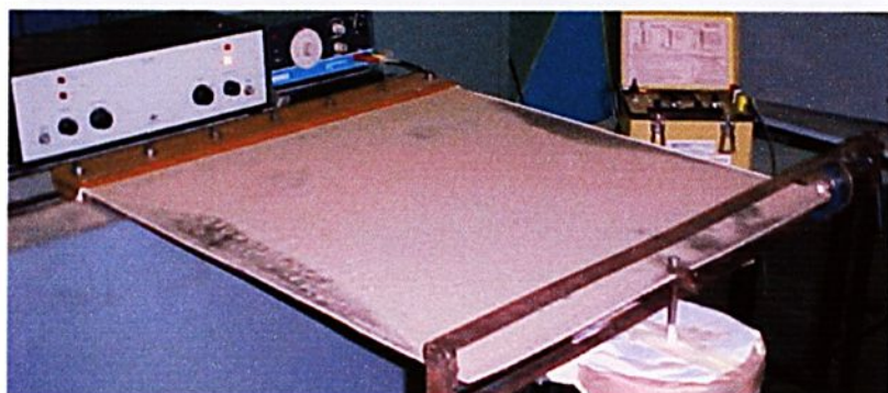
FIGURA 8.102 - Exper.(NL) modo 3 - Frequência natural 32,50 Hz - F=800\text{N}
