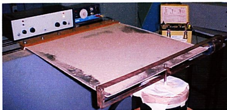
FIGURA 8.88 - Exper.(NL) modo 4 - Frequência natural 46,00 Hz – F=28N
