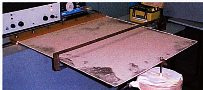
FIGURA 8.60 - Exper.(NL) modo 6 - Frequência natural 76,20 Hz – F=3000\text{N}
