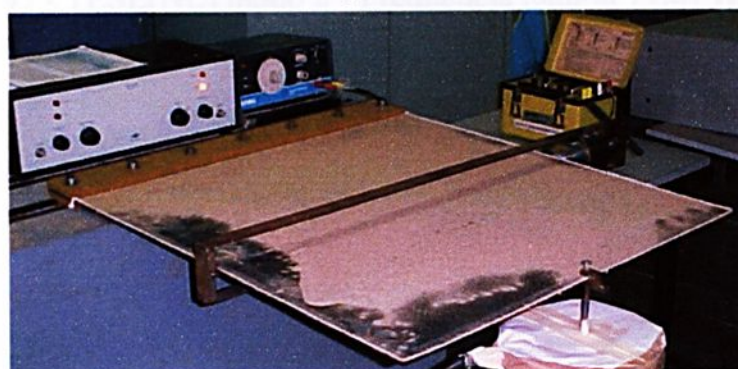
FIGURA 8.40 - Exper.(NL) modo 4 - Frequência natural 38,50 Hz - F=2000N
