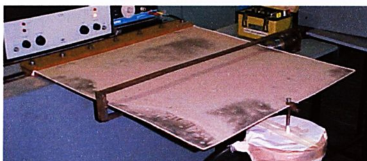
FIGURA 8.62 - Exper.(NL) modo 7 - Frequência natural 86,10 Hz – F=3000N
