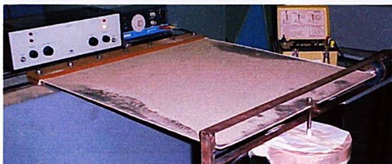
FIGURA 8.136 - Exper.(NL) modo 4 - Frequência natural 38,50 Hz- F=1400\text{N}
