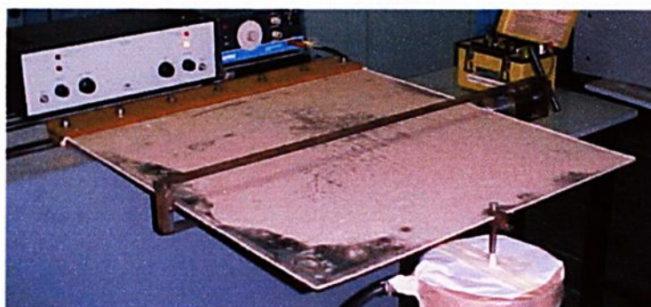
FIGURA 8.24 - Exper.(NL) modo 4 - Frequência natural de 37,87 Hz - F=1000\text{N}
