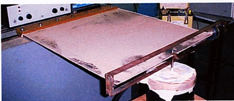
FIGURA 8.92 - Exper.(NL) modo 6 - Frequência natural 86,75 Hz – F=28\text{N}
