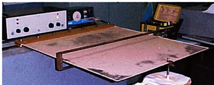
FIGURA 8.14 - Exper.(NL) modo 7 - Frequência natural de 85,50 Hz – F=28\text{N}
