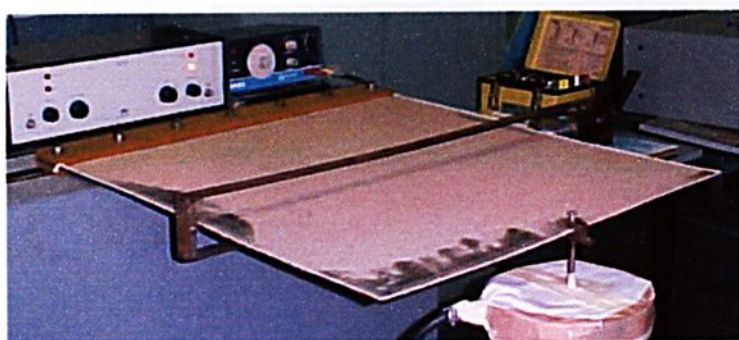
FIGURA 8.4 - Exper.(NL) modo 2 - Frequência natural de 14,00 Hz – F=28\text{N}
