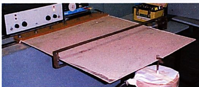
FIGURA 8.66 - Exper.(NL) modo 1 - Frequência natural 5,00 Hz – F=3500\text{N}
