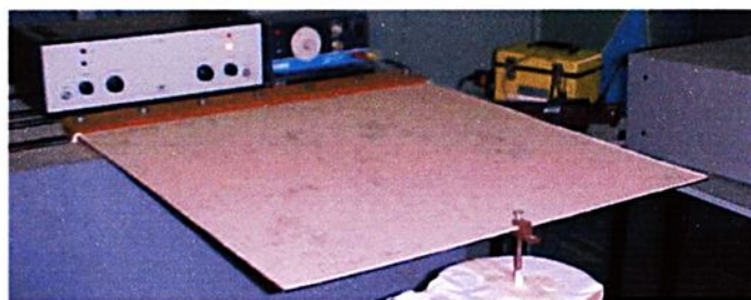
FIGURA 9.3 - Modo 1 - Experimental(L) - Frequência natural de 5,20 Hz
