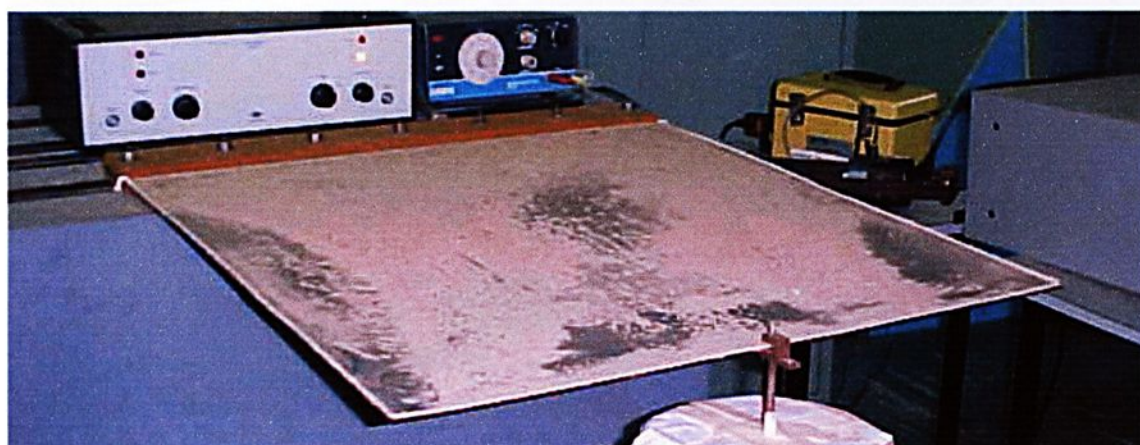
FIGURA 6.8 - Experimental(L) modo 4 - Frequência natural de 41,20 Hz
