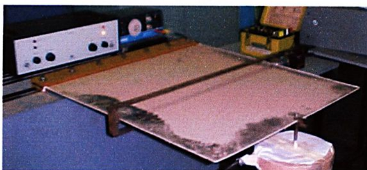
FIGURA 8.56 - Exper.(NL) modo 4 - Frequência natural 35,20 Hz – F=3000N
