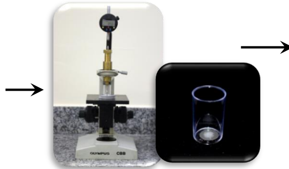
Microabrasão. Remoção de uma camada de 50 \mu\text{m} com lixa adesiva de granulação 400 adaptada ao frasco J-10
