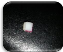
Uniao do bloco de esmalte bovino ao c-d-p com auxílio de cera pegajosa
