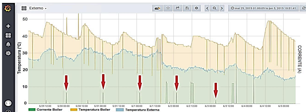
Figura 53 – Indicação de ativação do sistema auxiliar de aquecimento do boiler
