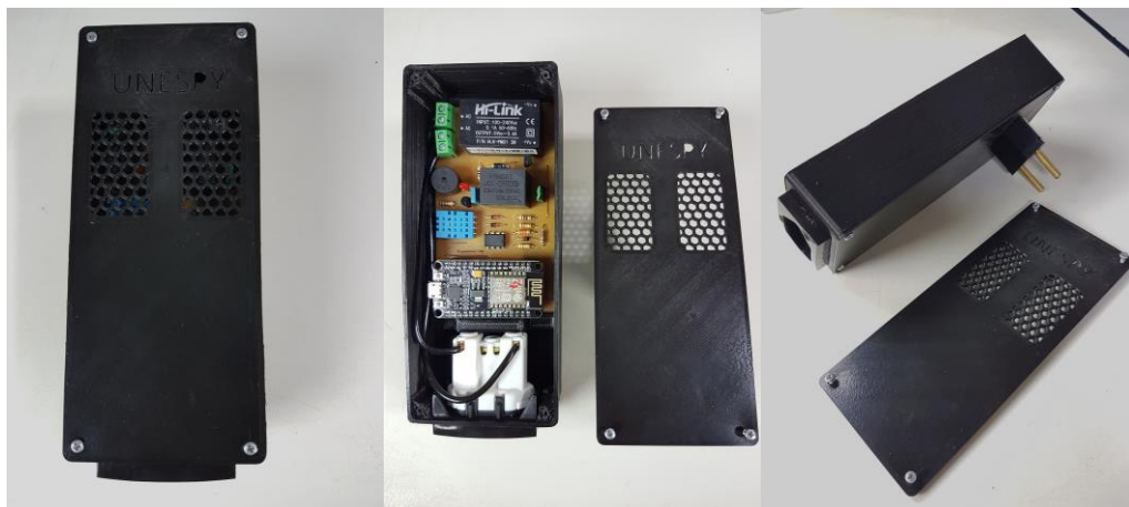
Figura 28 – Endpoint Unespy acondicionado em gabinete plástico, com plugue e tomada de energia
