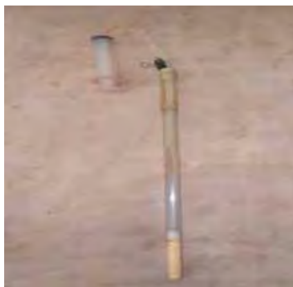
Figura 1. Extrator com cápsula porosa utilizado no experimento
