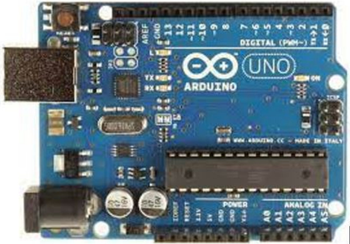
Figura 1 – Arduino UNO R3
