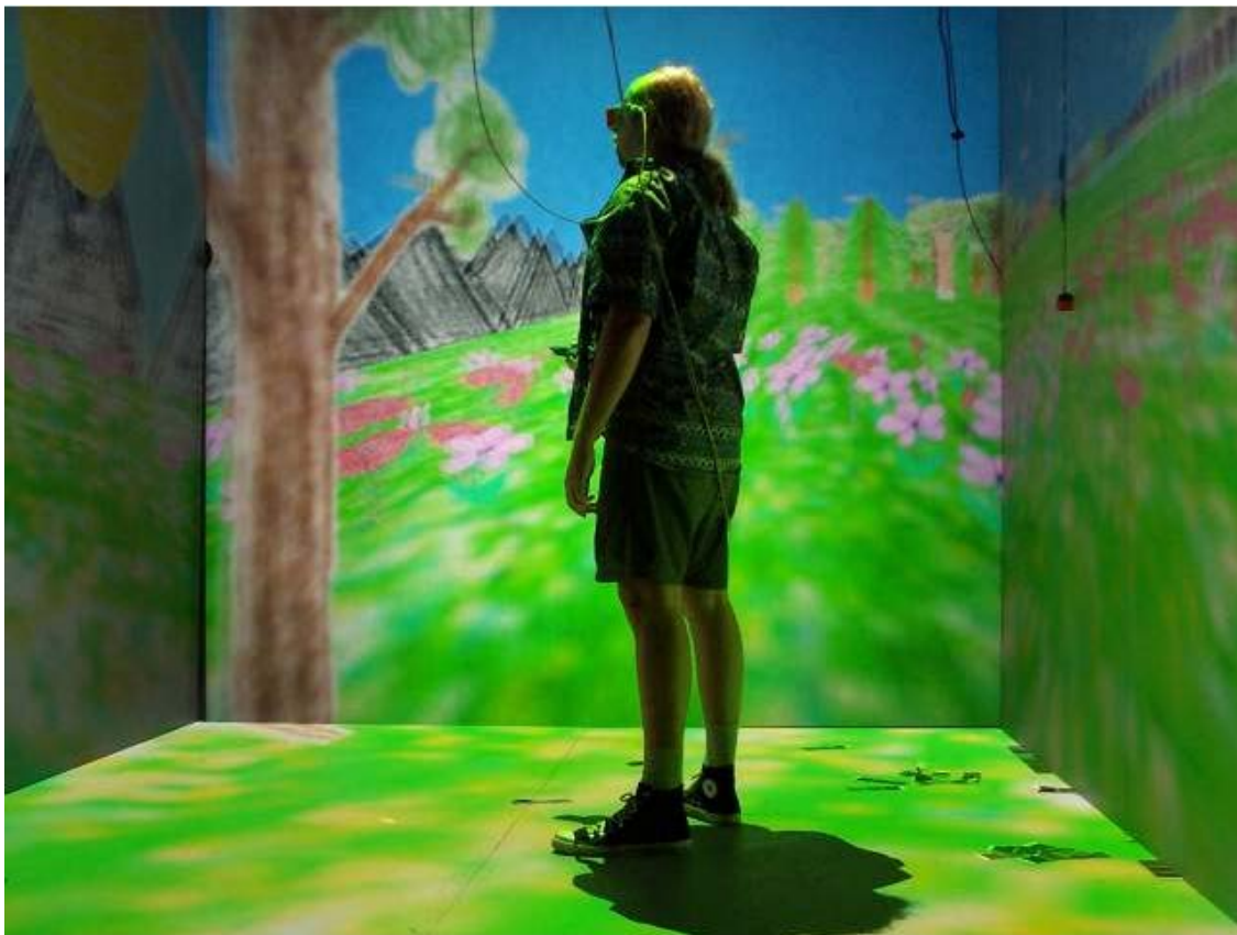
Figura 1 – O CAVE TM : Quatro projeções sincronizadas e contínuas de um mesmo Ambiente Virtual dispostas em forma de cubo.
