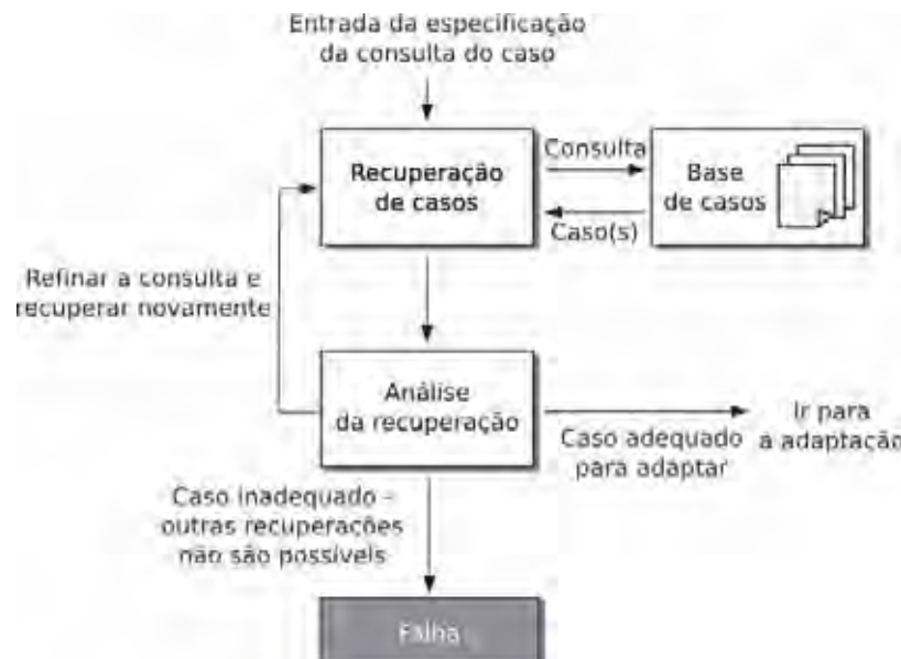
Figura 2: Processos envolvidos no RBC. Fonte: Adaptado de Pal & Shiu (2004)
