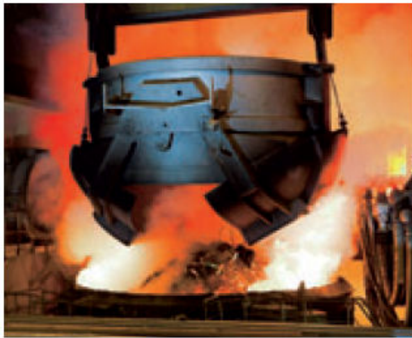
Figura 2.13: Gases de exaustão gerados durante carregamento de um forno elétrico a arco coletados pelo sistema de sucção secundário
