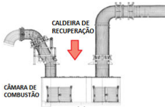
Figura 3.10 – Vista frontal da câmara de combustão do sistema de despoeiramento com indicação do local de instalação do recuperador de calor.
