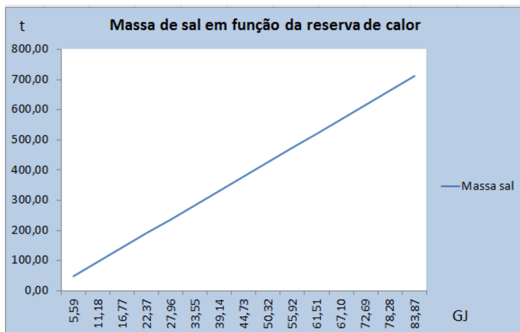
Figura 4.2 - Variação da massa de sal em função da reserva de calor requerida no tempo.
