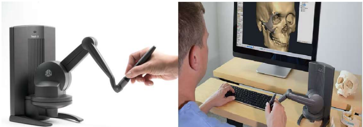
Figura 2. 19 – A esquerda uma visão do Touch X em comparação com a mão de um usuário. A direita o Touch X sendo utilizado em uma aplicação médica. Disponível em < https://www.3dsystems.com/haptics-devices/touch-x > Acesso em 20 nov 2022.
