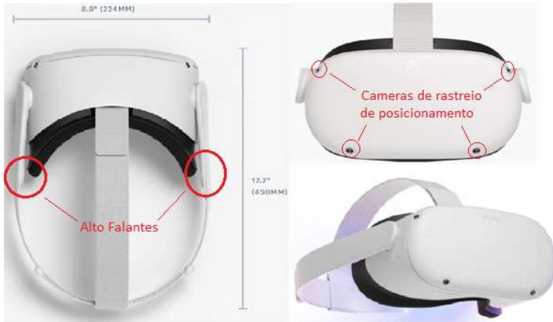
Figura 2. 14 – Visões externas do HMD Oculus Quest 2, demonstrando as câmeras de rastreamento de posicionamento e os alto falantes embutidos. Disponível em < https://www.meta.com/quest/products/quest-2/ >. Acesso em 20 nov. 2022.
