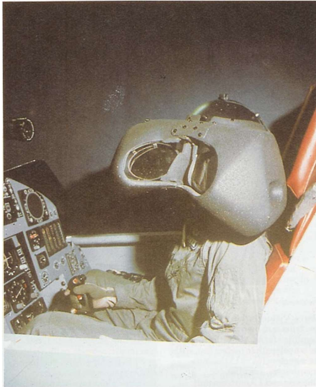
Figura 2. 8 – Simulador de voo Super Cockpit, demonstrando os controles similares de uma aeronave e o capacete com os visores de CRT sendo utilizado por um usuário.
