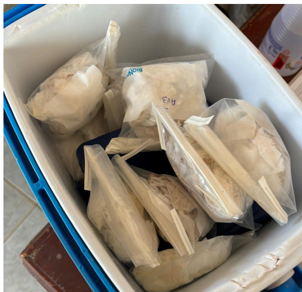
Figura 4 - Caixa térmica contendo placas de gelo e amostras de suabes colhidos em galpões durante vazio sanitário para análise posterior.
