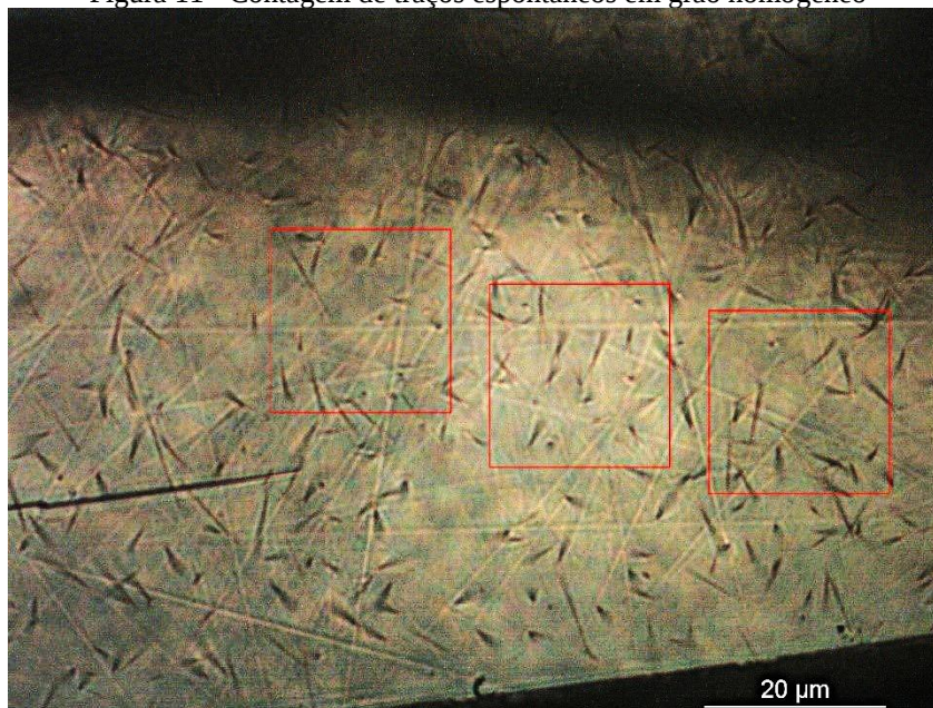
Figura 11 - Contagem de traços espontâneos em grão homogêneo
