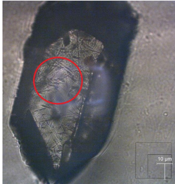
Figura 14 - Micrografia de zircão com região delimitada para o laser com luz transmitida e aumento nominal de 500x
