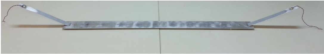
Figura 9: Método FRF utilizando o método de instalação MWBEMI.
