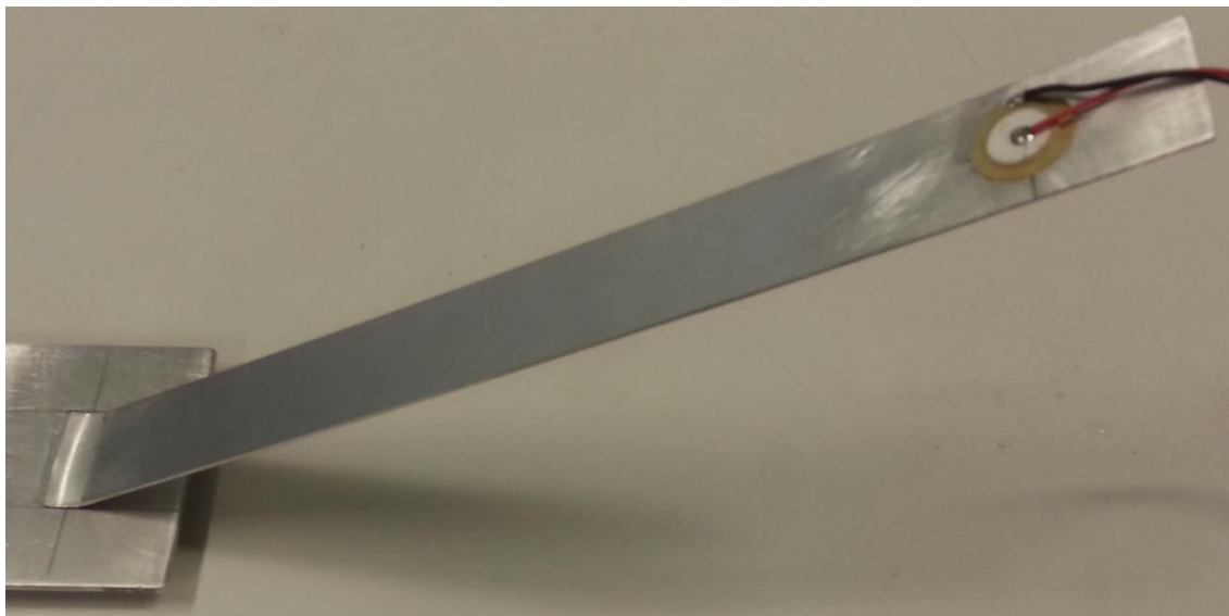
Figura 7: Método de instalação MWBEMI.
