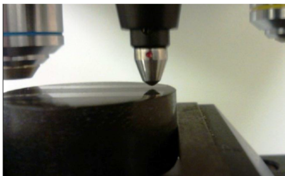
Figura 50 - Indentação da amostra
