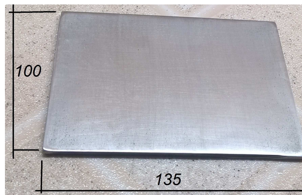
Figura 34 - Chapa cortada nas medidas 135 x 100 x 3,5 [mm] após limpeza.
