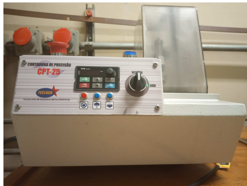
Figura 45 - Cortadeira metalográfica de precisão TECLAGO, modelo CPT-25.
