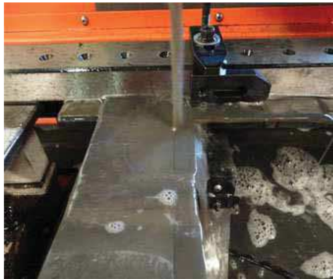
Figura 39 – Usinagem dos corpos de prova utilizando eletroerosão a fio.
