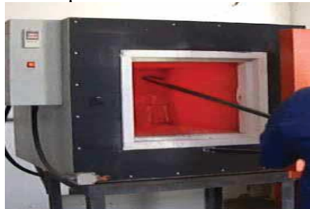
Figura 40 - Forno utilizado para o tratamento térmico de revenimento.
