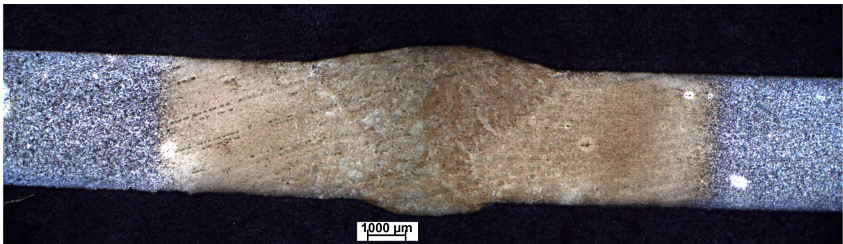
Figura 69 - Visão geral do material soldado a plasma com metal de adição sem tratamento térmico, transição entre MB, ZTA e ZF, 12,5x. (MO)Nital 3%.
