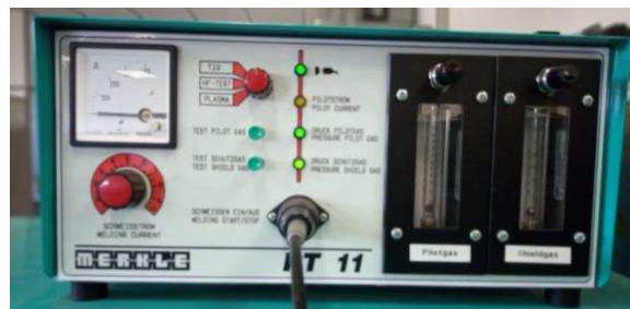
Figura 28 - Módulo de plasma da marca MERKLE BALMER modelo PT 11.
