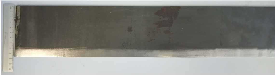
Figura 26 - Chapa cortada nas medidas 450 x 100 x 3,5 [mm] após limpeza.
