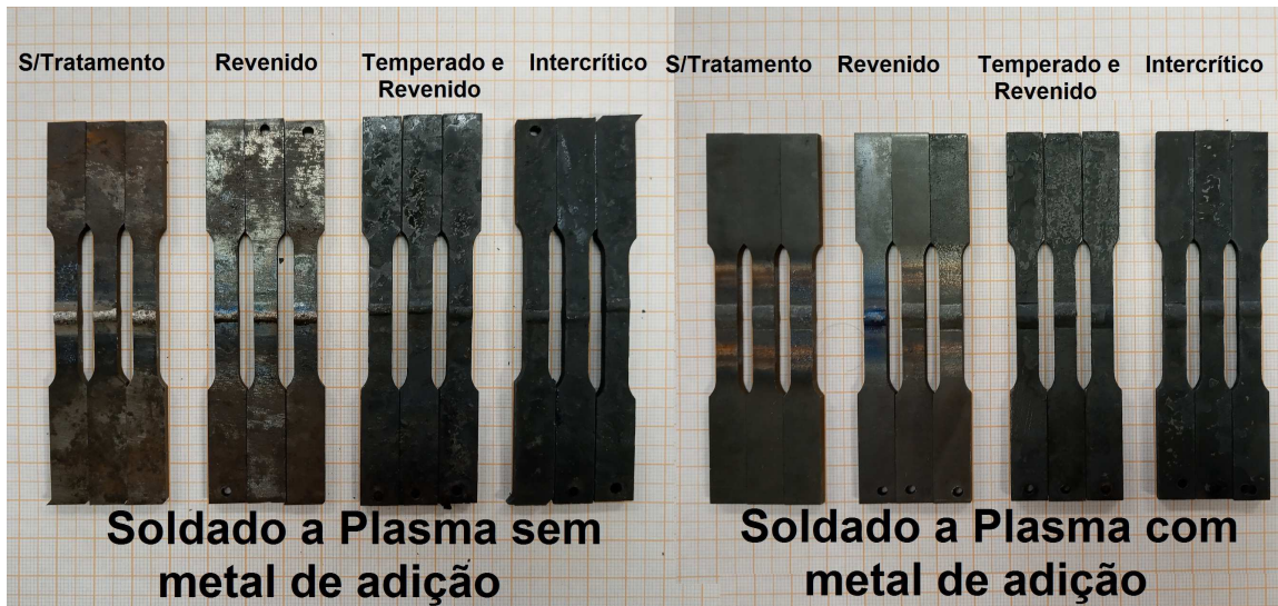
Figura 54 - Cdps soldados a plasma sem e com metal de adição, tratados e não tratados termicamente.
