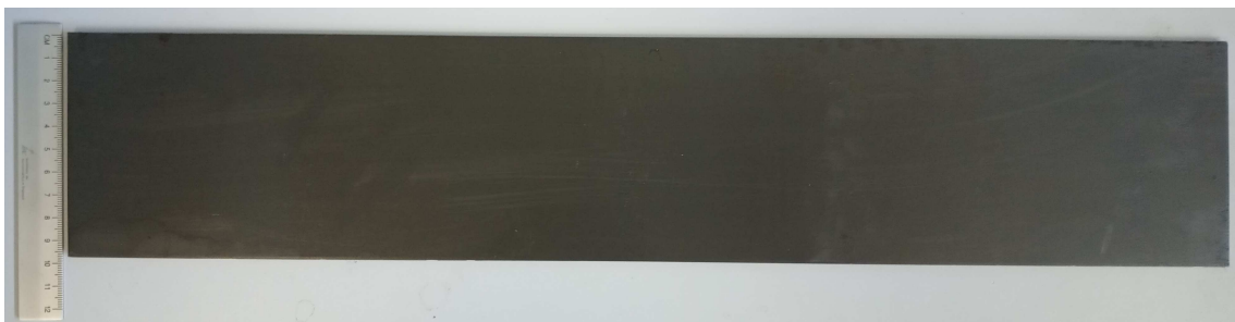
Figura 25 - Chapa cortada nas medidas 450 x 100 x 3,5 [mm] antes da limpeza.
