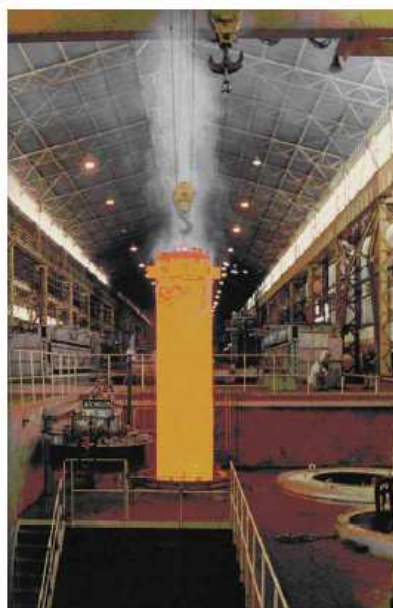
Figura 13 - Tratamento térmico em envelope motor de foguete.
