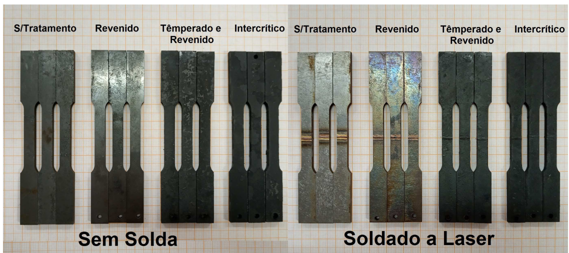
Figura 53 - Cdps sem solda e soldados a laser, tratados e não tratados termicamente.
