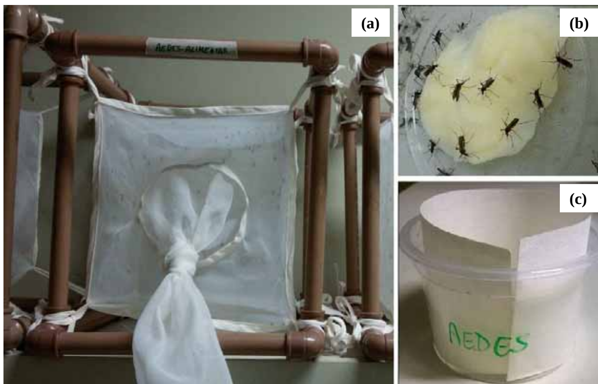
Figura 5. (a) Gaiola para acondicionamento dos mosquitos adultos, (b) algodão com solução de glicose para alimentação e (c) pote para oviposição.
