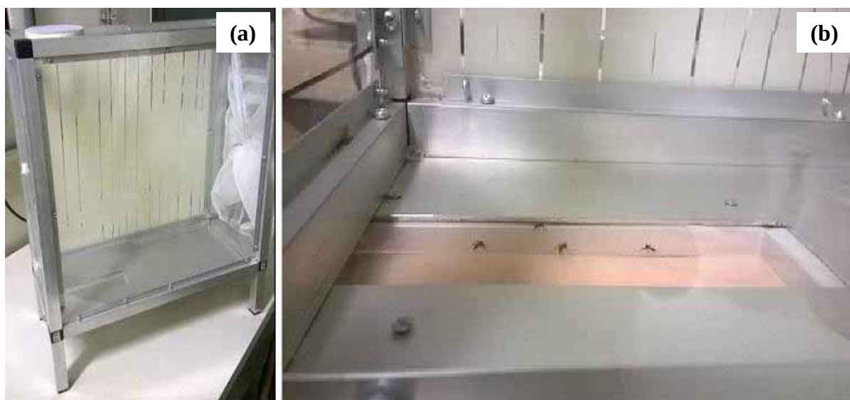
Figura 6. (a) Vista geral da BG-cage e (b) vista da abertura onde os voluntários expõem o antebraço, com destaque para a tela na qual os mosquitos pousam.
