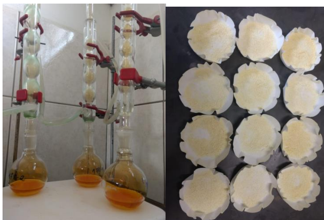
Figura 7. Determinação do teor de celulose pelo método do ácido nítrico.
