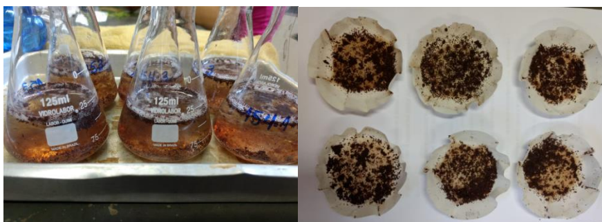
Figura 6. Determinação do teor de lignina pelo método de Klason
