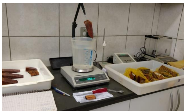
Figura 4. Determinação da densidade básica da madeira pelo método de imersão em água.
