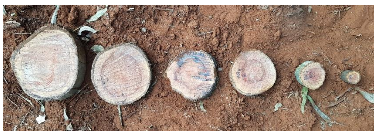
Figura 2. Discos correspondentes aos pontos de amostragem, 0%, DAP, 25%, 50%, 75% e 100% da altura comercial.
