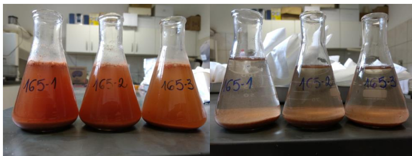
Figura 5. Procedimento de eliminação dos extrativos, com a troca de água até permanecer com aparência incolor.
