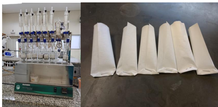
Figura 8. Digestor e cartuchos de papel utilizados na determinação do teor de extrativos
