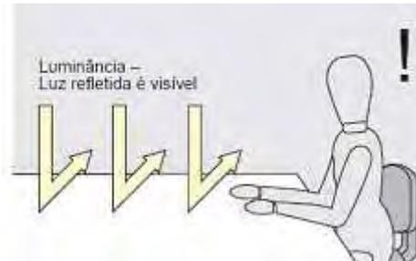
Figura 8. Luminância. Fonte: OSRAM (2003)
