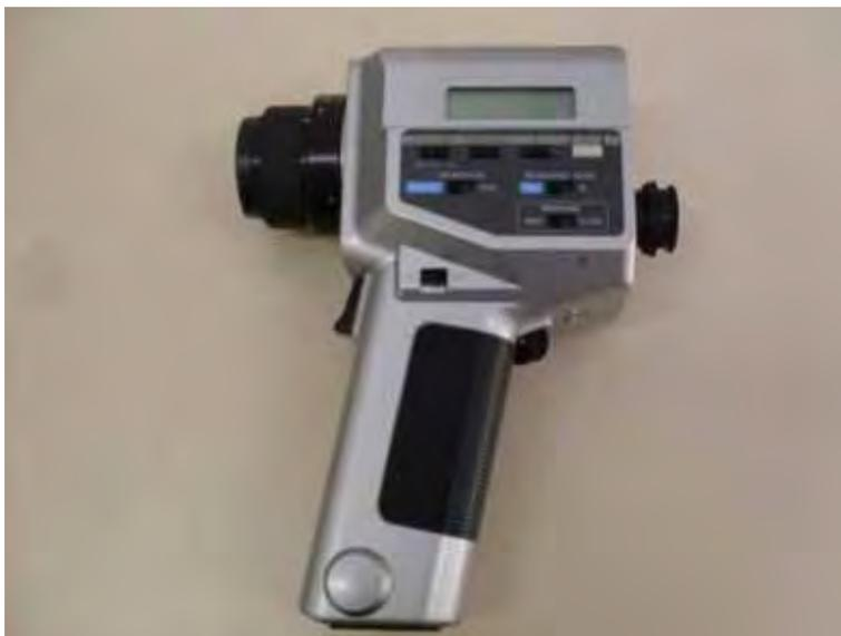
Figura 15. Luminômetro LS -110
