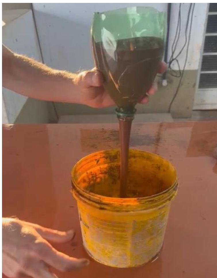
Figura 4 – Ensaio de escoamento confinado.
