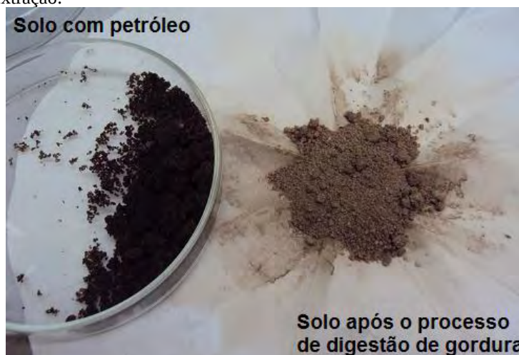
Figura 23 - Solo contaminado com petróleo antes do processo de extração de gordura e o mesmo solo após processo de extração.
