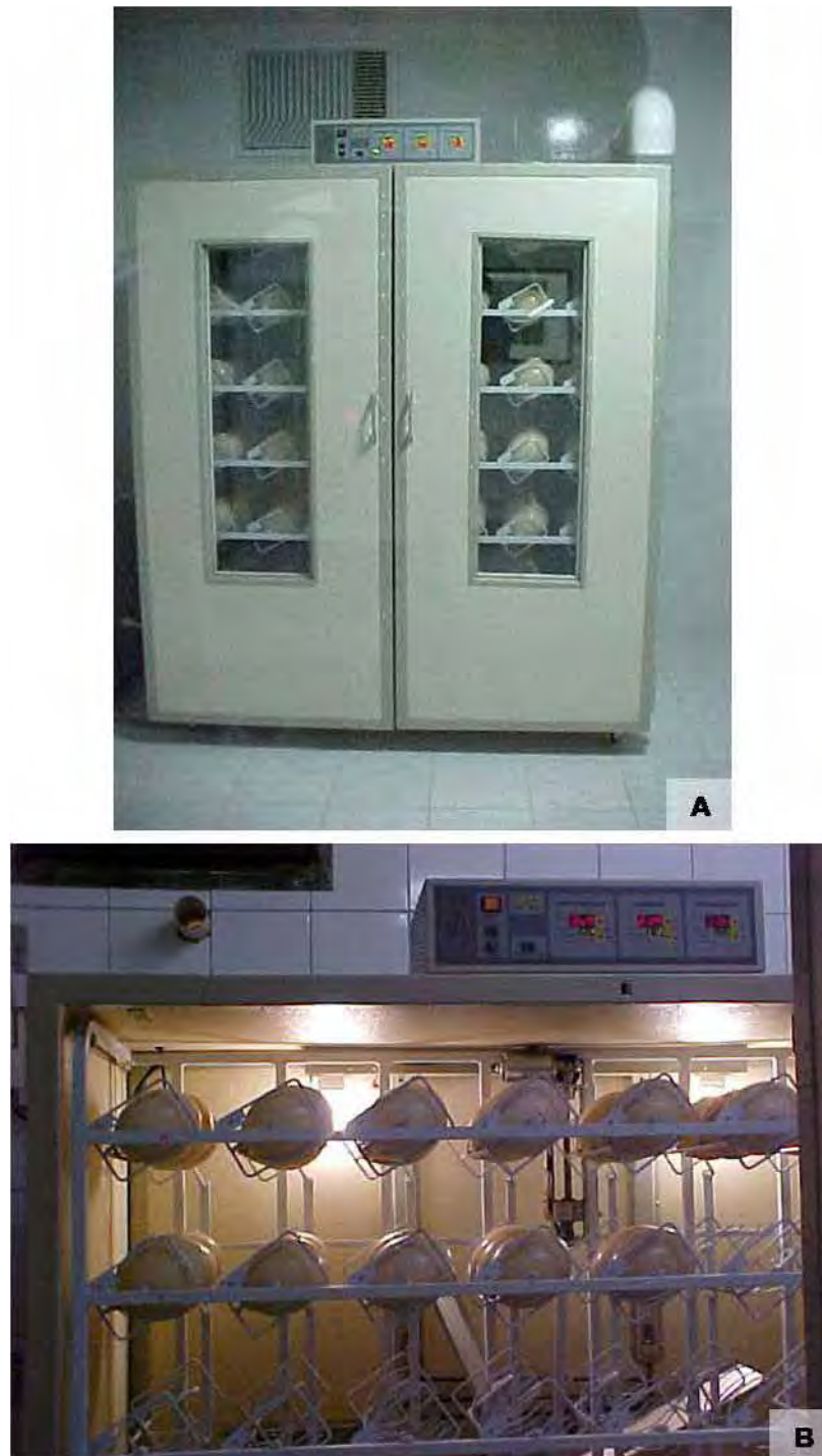
Figura 2. Sala de incubação. A. gabinete incubadora de ovos de avestruzes. B. detalhes do interior da incubadora.
