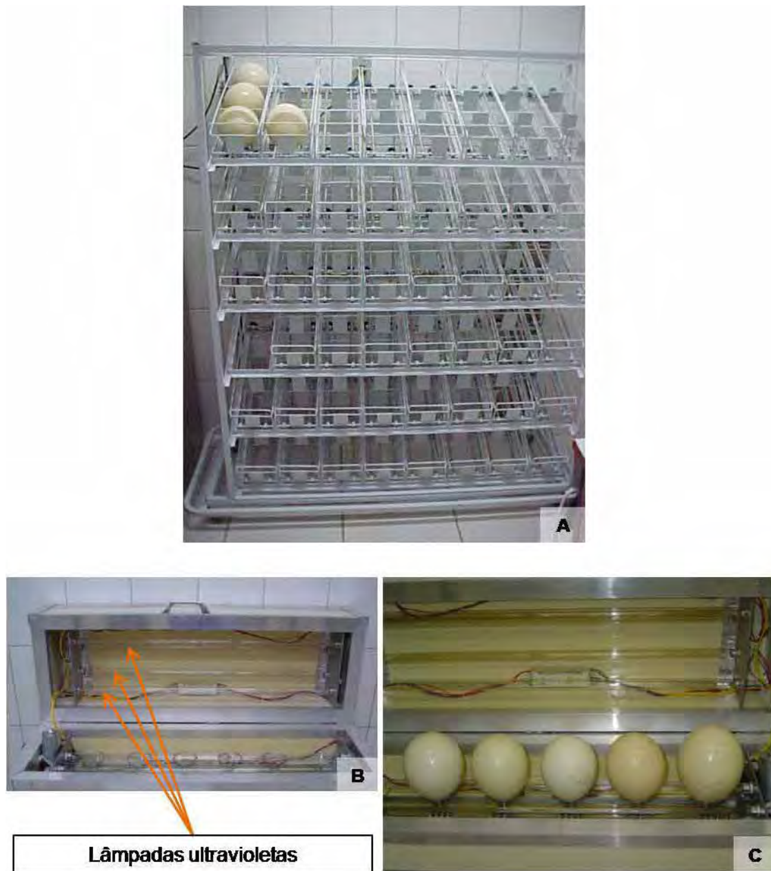
Figura 1. Equipamentos utilizados para o armazenamento e a desinfecção de ovos de avestruzes. A. estrutura para armazenamento dos ovos com movimento programável automático de rotação. B. máquina para desinfecção dos ovos, por meio de radiação ultravioleta. C. mesmo que o anterior, mostrando a acomodação dos ovos.
