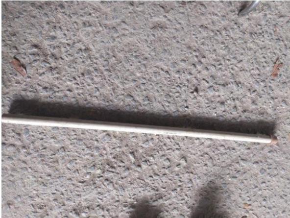
Figura 7: Cano 25mm - 1 peça de 74 cm
