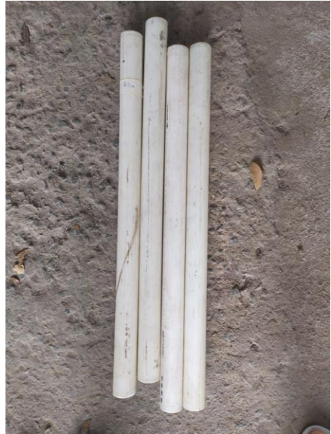
Figura 8: Cano 40 mm - 4 peças de 63 cm
