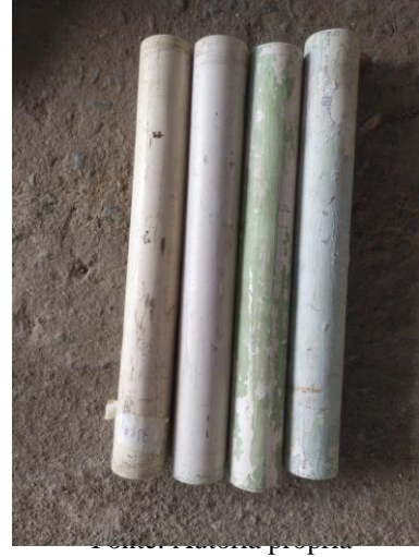
Figura 12: Cano 40 mm - 4 peças de 31 cm
