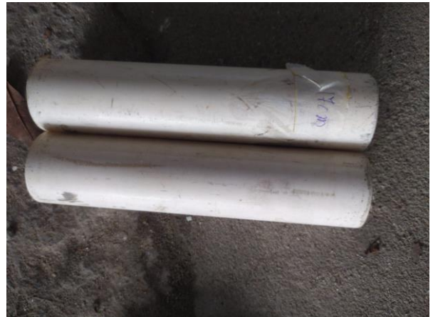
Figura 10: Cano 40 mm - 2 peças de 17 cm
