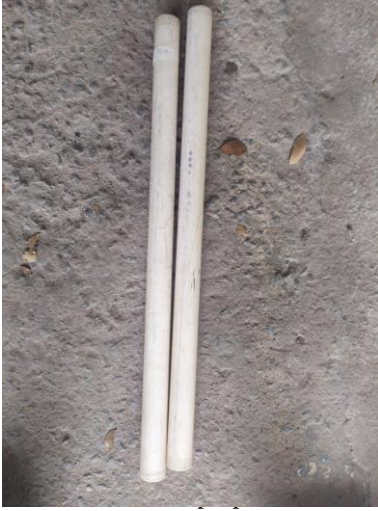
Figura 11: Cano 40 mm - 2 peças de 70 cm
