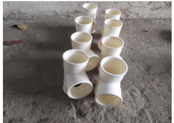
Figura 18: 8 T de 40 mm
