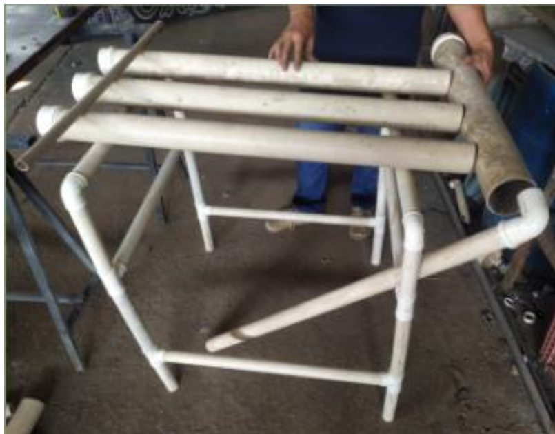
Figura 4: Estrutura física do sistema hidropônico
