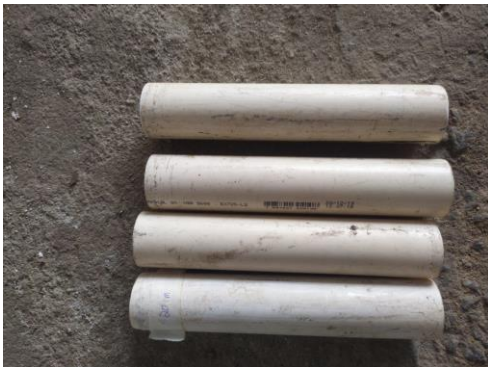
Figura 13: Cano 40 mm - 4 peças de 20 cm
