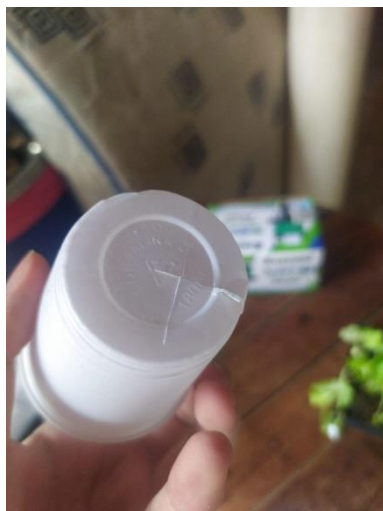
Figura 6: Corte feito na parte de baixo do copo plástico
