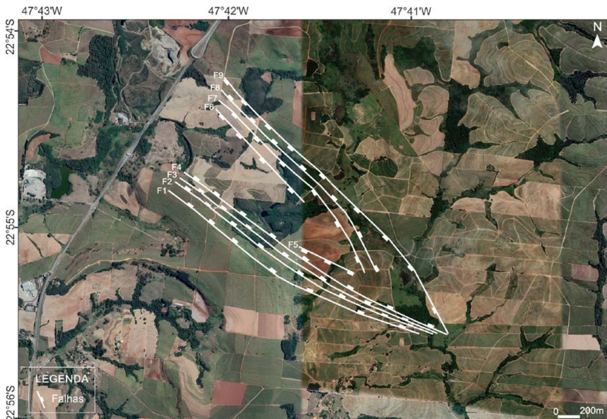
Figura 33: Mapa estrutural da porção sudoeste do Gráben do Serrote, elaborada com a integração dos dados das seções de tomografia elétrica e análises estruturais coletadas em campo.
