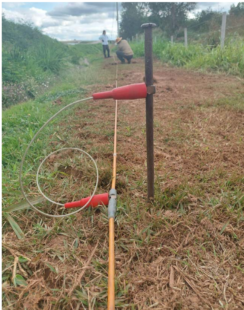
Figura 3: Eletrodo introduzido no solo acoplado ao cabo de transmissão/corrente
