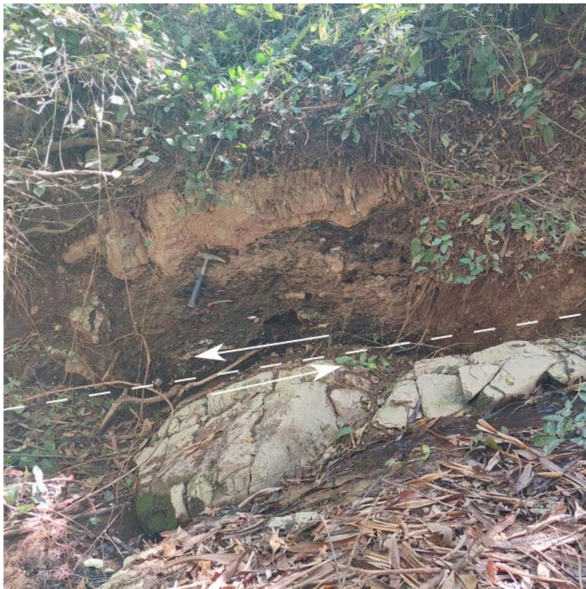
Figura 24: Falha antitética NW-SE no ponto 5.
