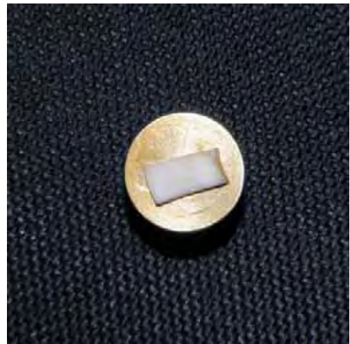
Figura 13 - Espécime tratado, colado em "stub" metálico.
