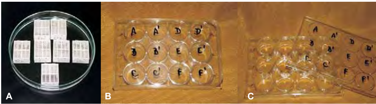
FIGURA 11 - A) Desidratação em concentrações crescentes de álcool. B e C) Placas de acrílico codificadas para aplicação do HMDS.
