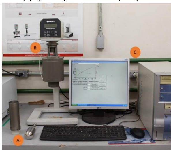
Figura 5 – Sistema de medição reologia: (A) Sistema CC 45; (B) Reômetro Brookfield R/S, (C) Computador de aquisição de dados
