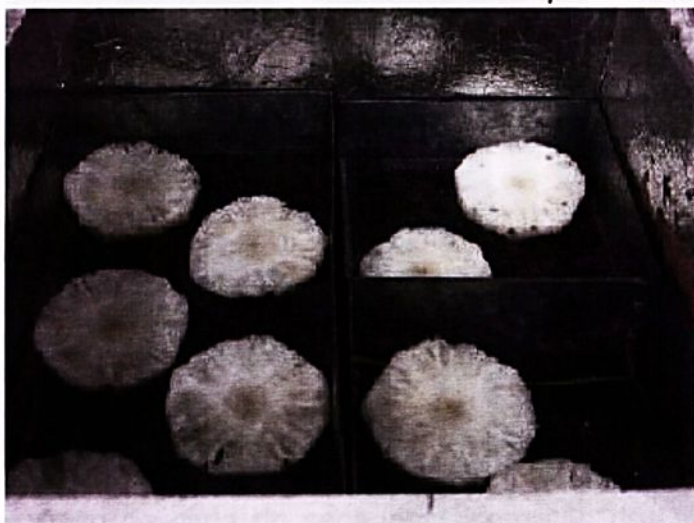
Figura 3.3 – Disposição das bandejas com as fatias dentro do secador
