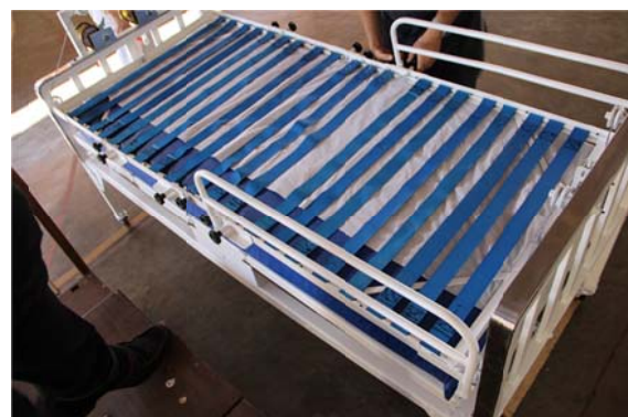
Figura 1. Montagem da cama hospitalar especial após a pintura.
