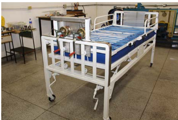
Figura 5. Isolamento por chapas de alumínio do mecanismo de movimento decúbico.
