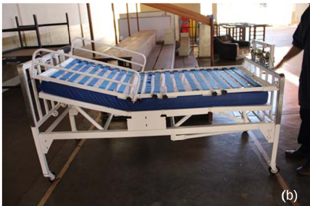
Figura 2. Ação dos manípulos nas junções da cabeceira (a) para garantir o movimento na posição sentada (b).
