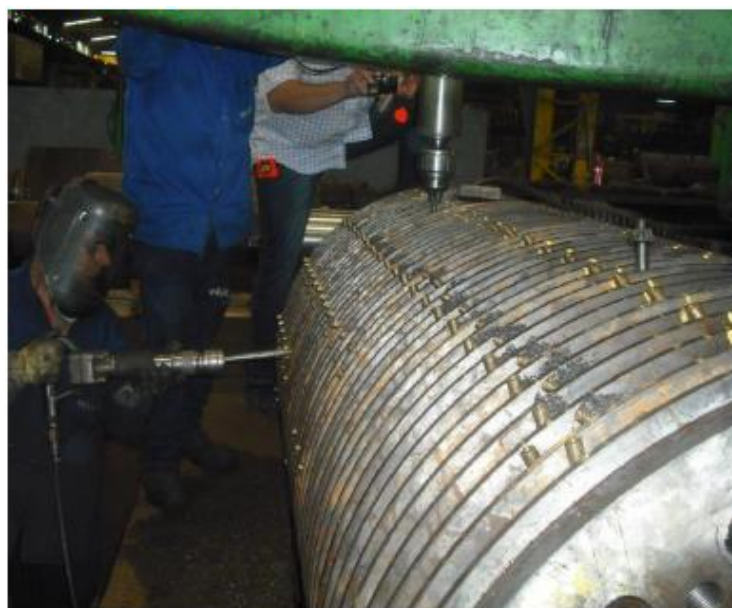
Figura 58 - Montagem das boquilhas de bronze no rolo Lótus.
