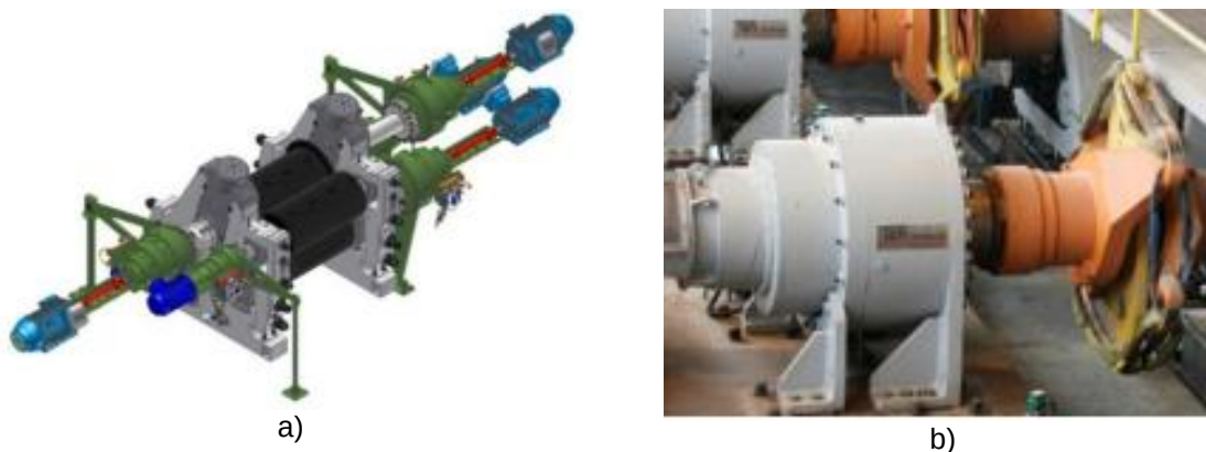
Figura 71 - Acionamento com redutor planetário: a) Individual; b) Central.
