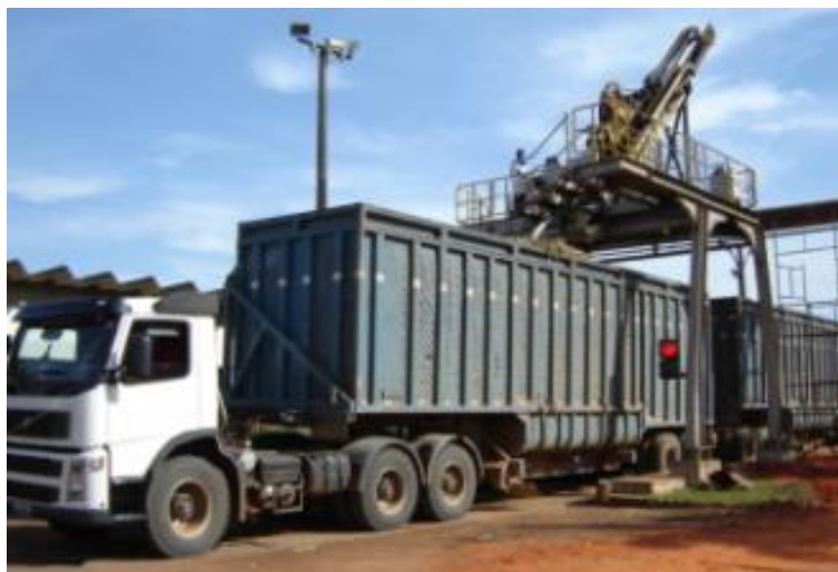
Figura 22 - Amostragem de cana para avaliação da qualidade.
