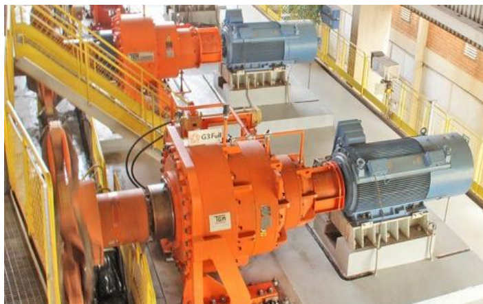
Figura 68 - Redutor planetário para acionamento de moenda.
