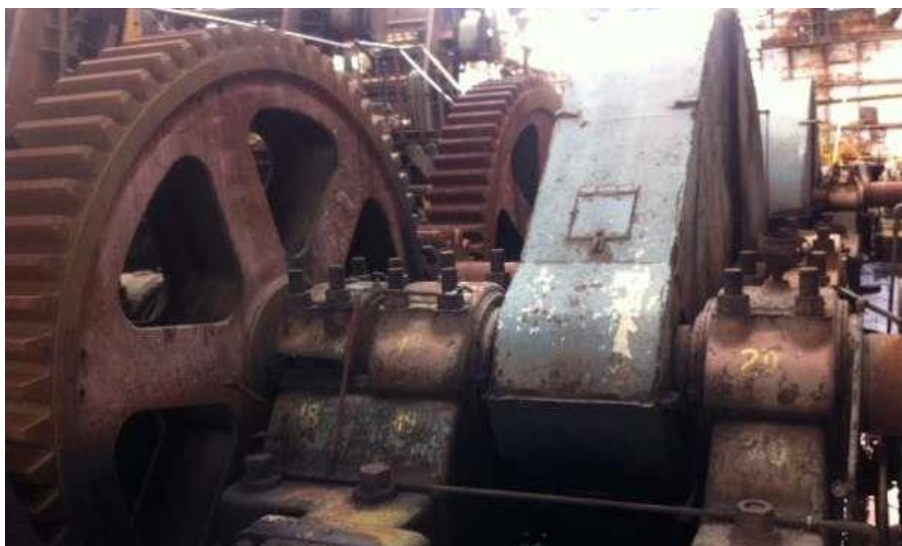
Figura 67 - Engrenagens de acionamento da moenda.
