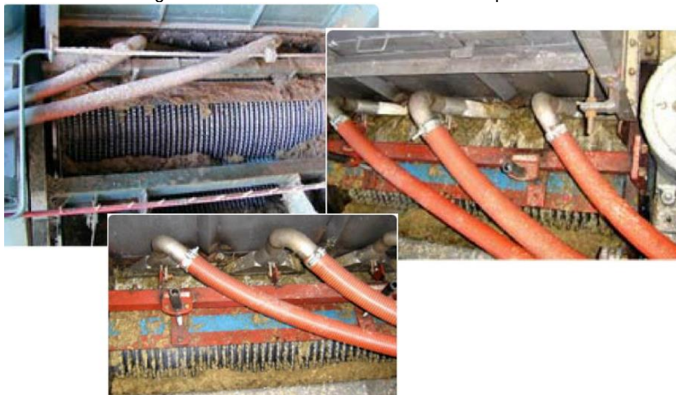
Figura 48 - Succionador de caldo no rolo superior.
