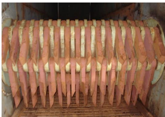
Figura 27 - Picador do sistema de preparo de cana.
