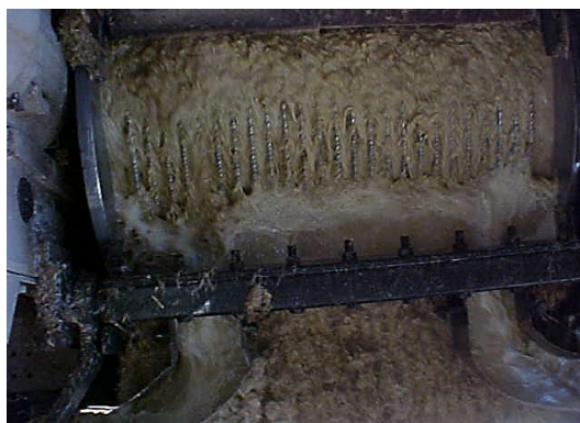
Figura 47 - Presença de caldo no rolo superior.
