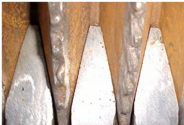
Figura 45 - Engrenamento dos frisos da camisa com os dentes da bagaceira.
