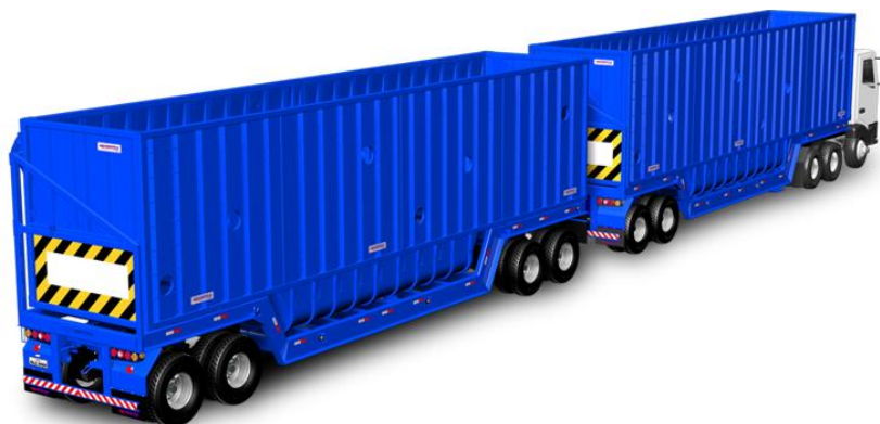
Figura 21 - Transporte de cana com rodotrem.
