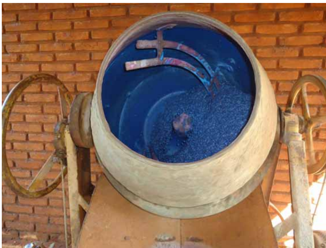
Figura 3- Tratamento de sementes com inseticida imidacloprido + tiodicarbe (45 + 135 g do i.a. por 100 kg) e fungicida carboxina + tiram (50 + 50 g do i.a. por 100 kg).
