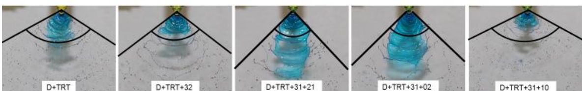
Figura 27 – Ilustração ângulos de abertura da ponta de pulverização TTI 11002 com a alteração da composição da calda na pressão de trabalho de 2 bar
