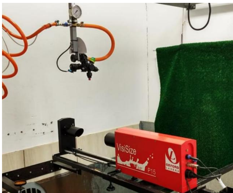
Figura 4 - VisiSize P15, Oxford Lasers, posicionado no Sistema de pulverização
