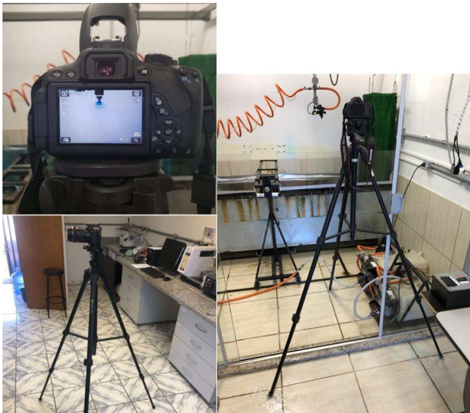
Figura 9 – Posicionamento da câmera Canon para captura das imagens da abertura dos ângulos
