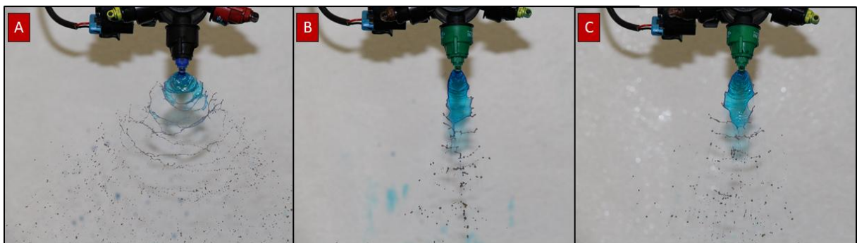
Figura 7 – Jato de pulverização com perfeita abertura do ângulo nas coletas de dados da ponta TTI 11003 a 1 bar aplicando a calda com o adjuvante redutor de deriva 32 (A) e jatos de pulverização sem a abertura adequada do ângulo de pulverização para a ponta TTI 110015 a 1 bar com as caldas contendo os adjuvantes 02 (B) e 21 (C)
