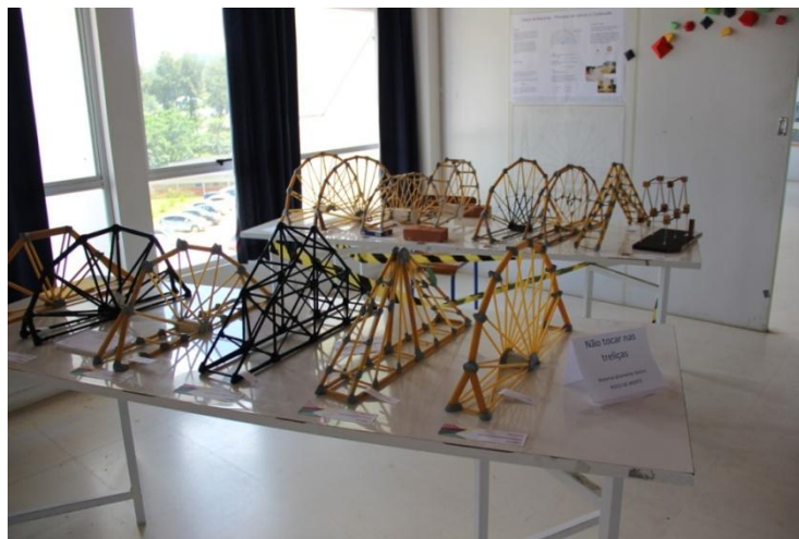
Figura 9 – Estruturas em treliça de espaguete
