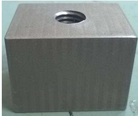
Figura 24 – Bloco de aço para a fixação da célula de carga
