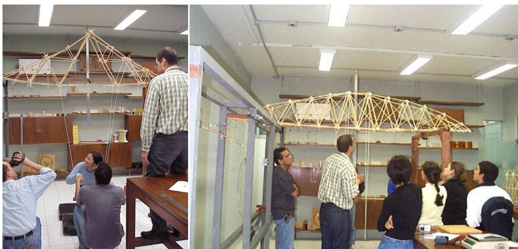
Figura 11 – Prova de carga da treliça
