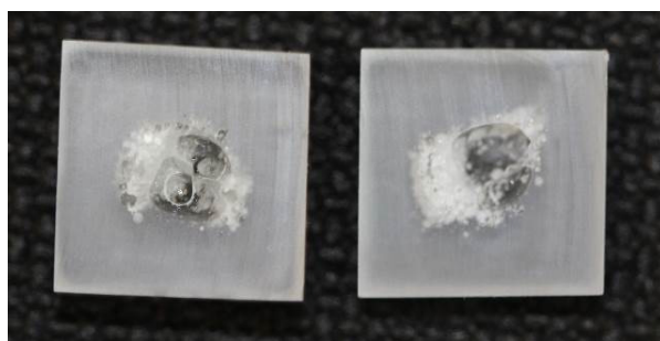
Figura 12 – Exemplo de cp de 8cm 3 seccionado e evidencia de bolhas no interior.
