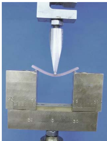
Figura 16- Dispositivos de teste de flexão e aplicação de carga sobre o cp realizado na EMIC.
