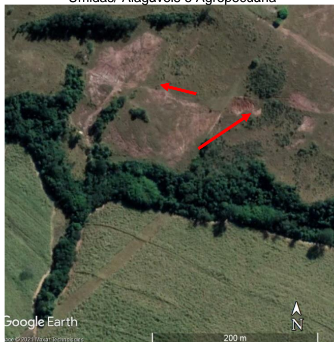
Figura 31: Processo erosivos de sulcos (setas vermelhas) identificados nos limites das zonas Áreas Úmidas/ Alagáveis e Agropecuária
