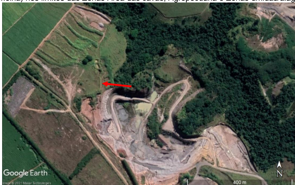
Figura 26: Ausência de cobertura vegetal e processos erosivos de sulcos e ravinamento (seta vermelha) nos limites das Zonas Área das cavas, Agropecuária e Zonas úmidas/alagáveis
