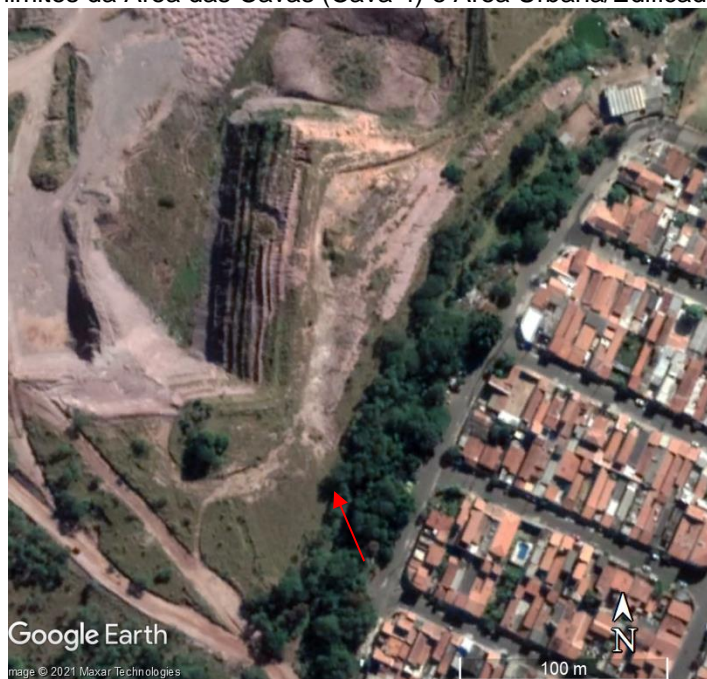
Figura 30: Ausência de cobertura vegetal natural e processos erosivos de sulcos (seta vermelha) nos limites da Área das Cavas (Cava 4) e Área Urbana/Edificada
