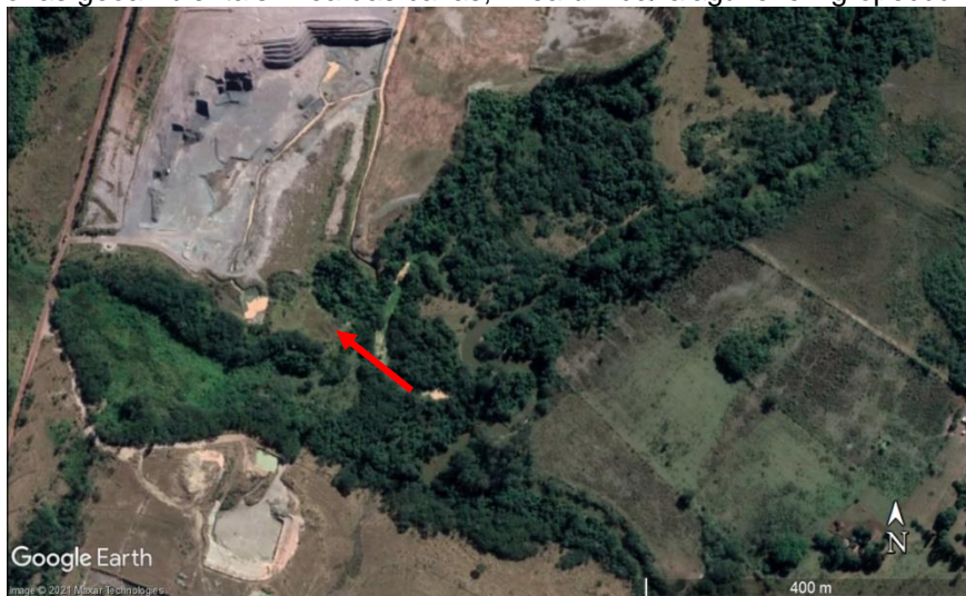
Figura 24: Processos erosivos de formação de sulcos (seta vermelha) identificados na junção das zonas geoambientais Área das cavas, Área úmida/ alagável e Agropecuária.
