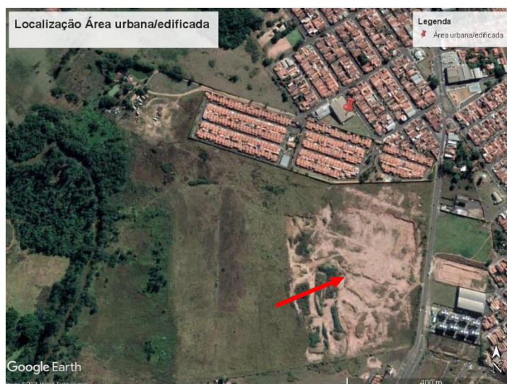
Figura 22: Processo erosivo identificado na área zona Urbana/edificada (seta vermelha)
