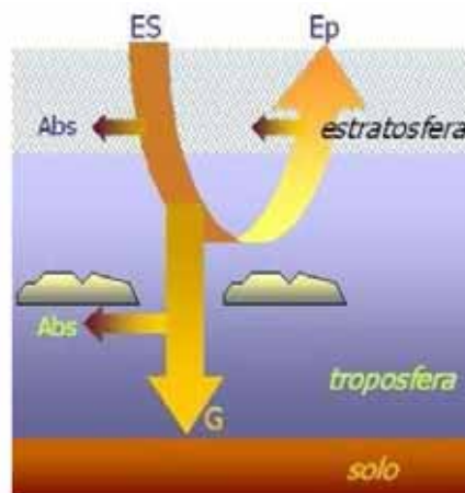
Figura 8 – Absorção e reflexão da radiação solar na atmosfera, conforme o modelo GL.
